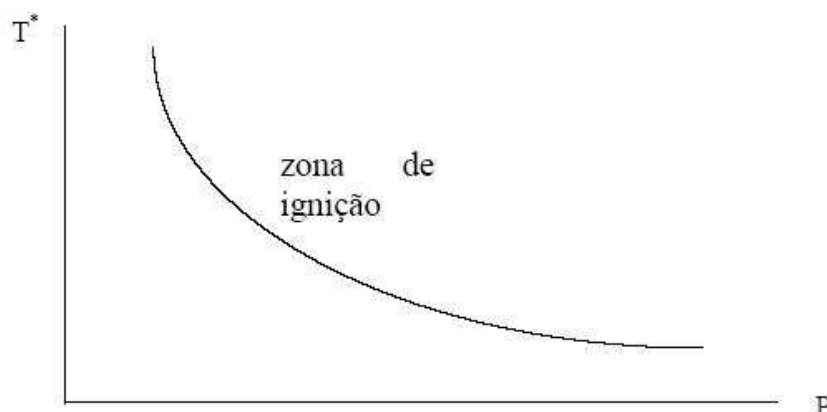
Figura A.2 – Gráfico qualitativo de temperatura de auto ignição x pressão, para uma dada mistura de combustível.
