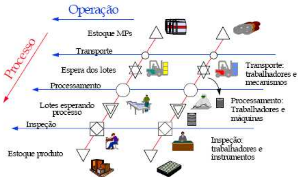
Figura 2 – Mecanismo da Função Produção: rede de processos e operações Fonte: Adaptado de Shingo (1996a)
