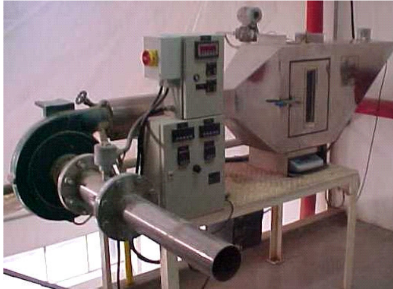
Figura 4.3: Foto do secador piloto utilizado no experimento de secagem.
