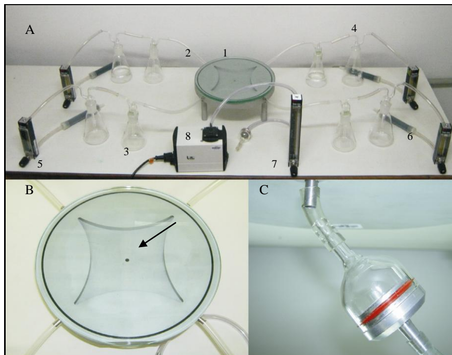
FIGURA 6. A) Olfatômetro de múltipla escolha: 1) arena; 2) tubo de silicone; 3) Erlenmeyer armadilha; 4) Erlenmeyer teste; 5) fluxímetro lateral; 6) tubo com carvão ativo; 7) fluxímetro central e 8) bomba de vácuo; B) detalhe da arena com orifício de liberação indicado por seta; C) câmara de liberação dos parasitóides.
