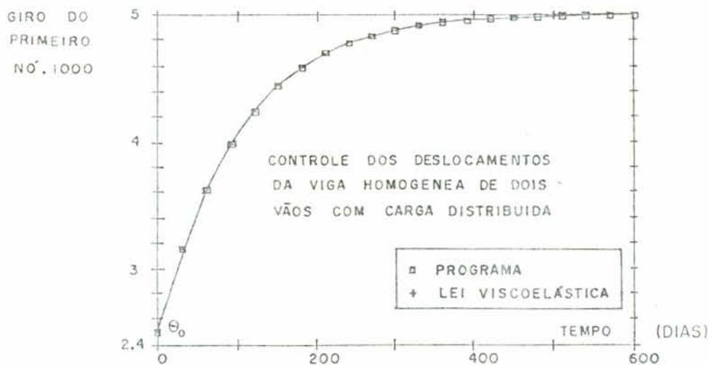
Fig. 9.2 - Experiência de creep para a viga da fig. 9.1.
