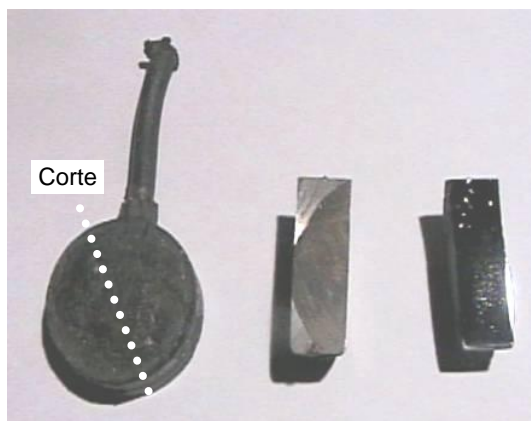
Figura 4.3 Amostra de aço, tipo de corte recomendado e, à direita, amostra cortada.
