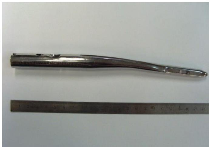
A prótese “B” é de Co-Cr-Mo ASTM F75, é frequentemente usada em superfície articular, constituindo assim o par tribológico com o polietileno (articulação polímero-metal) ou com ligas metálicas (articulação metal-metal). A Figura 3.2 mostra a prótese de onde o corpo de prova foi retirado. No caso é uma base tibial, que suporta uma placa de Polietileno de Alta Densidade, mas não tem movimento relativo com esse.
