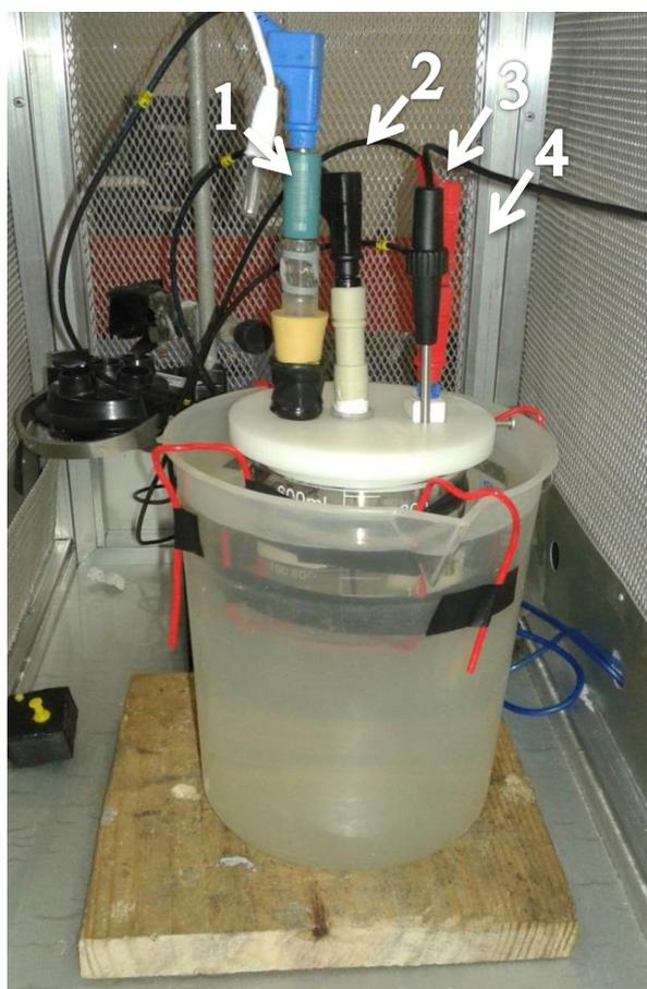
Um dispositivo de *Nylon*®, mostrado na Figura 3.8, foi usado para posicionar as amostras na célula eletroquímica. Uma fina camada de silicone *Protective Coating SG 250* – *HBM*® foi aplicada 24 horas antes do ensaio entre a amostra e o *o-ring* de vedação do dispositivo para evitar a corrosão por fresta.
