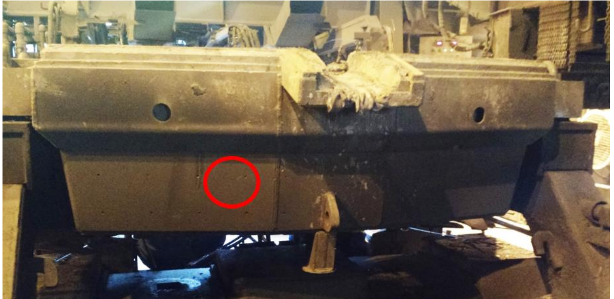
Figura 16 – Distribuidor usado no processo de lingotamento contínuo (GERDAU, 2015).
