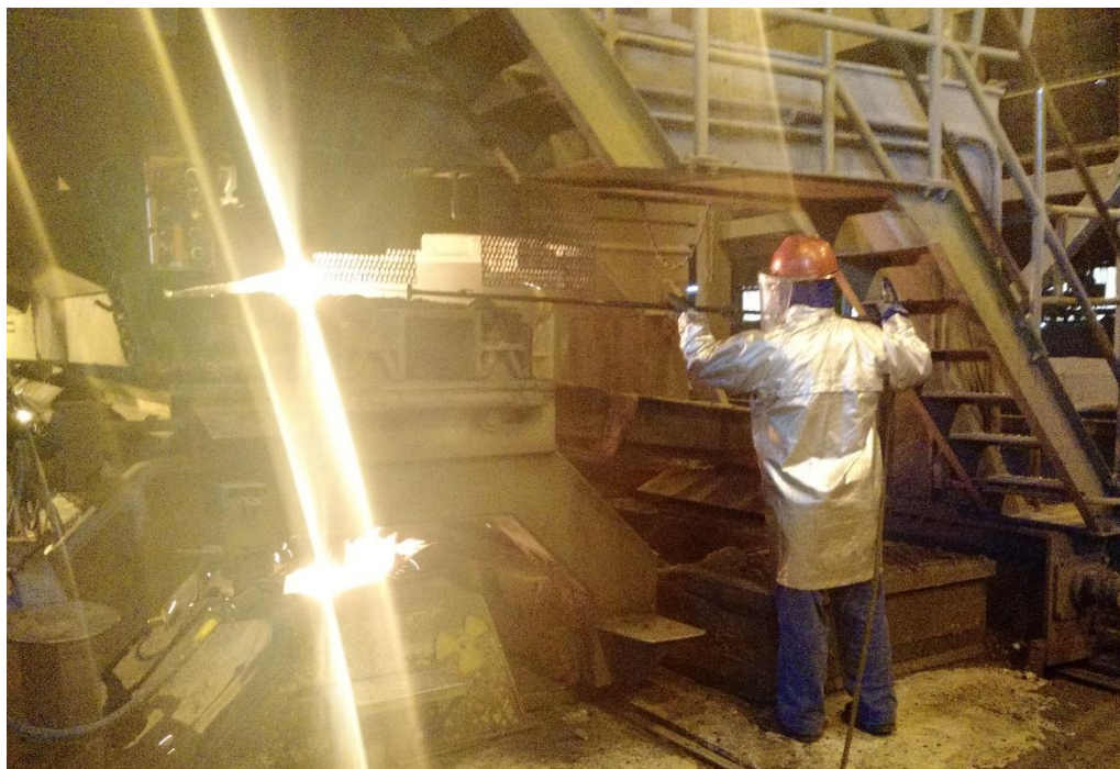
Figura 17 – Medida de temperatura utilizando termopar (GERDAU, 2005).
