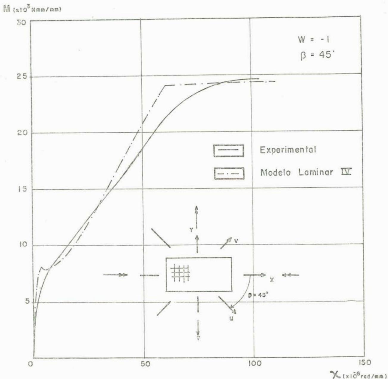
FIGURA 4.6 - Diagrama M- $\chi$  para a laje B16.
