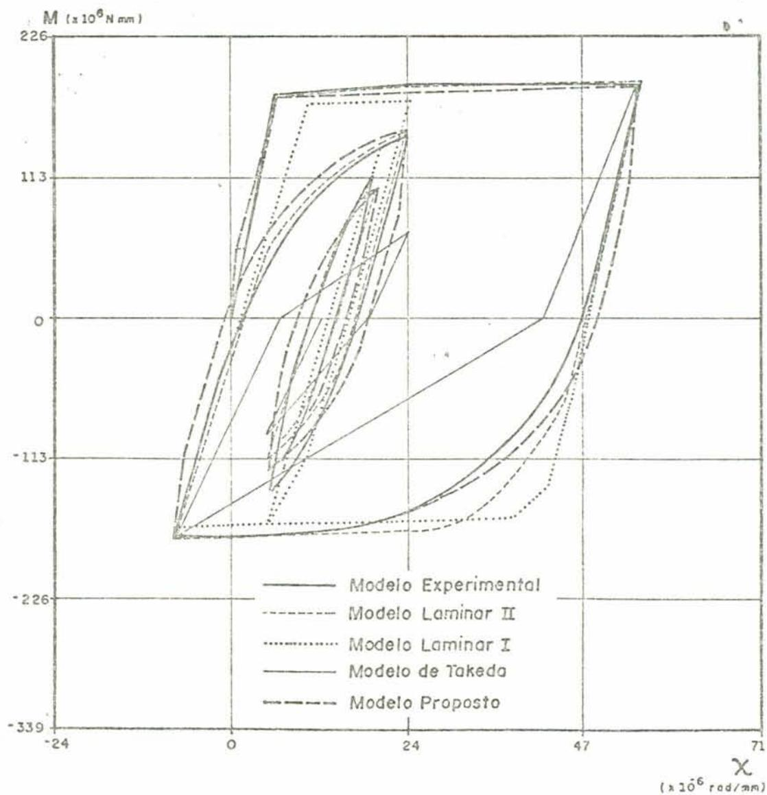
FIGURA 3.8 - Diagrama M-X para a viga 2 submetida a carregamento cíclico reverso.
