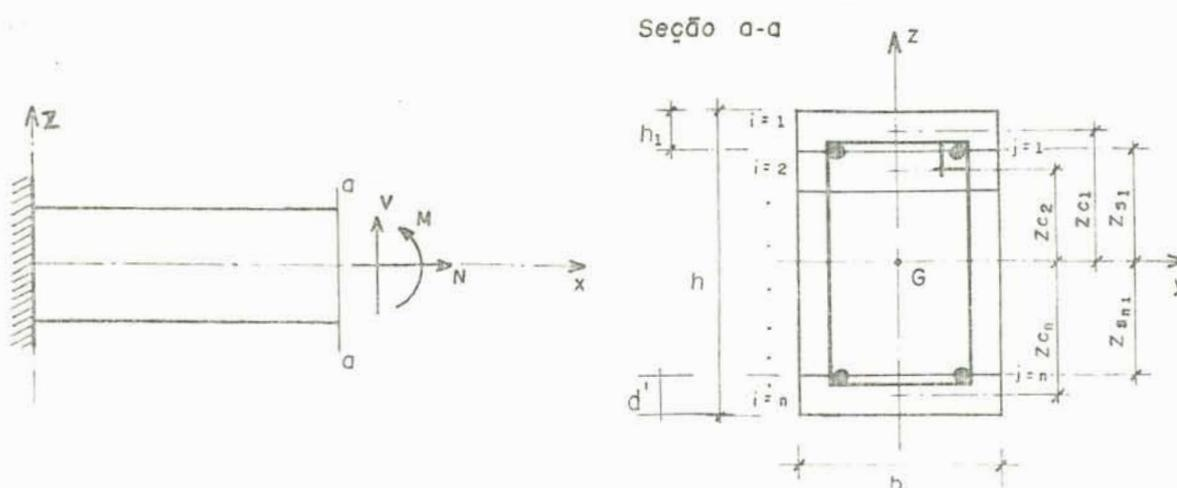
FIGURA 3.1 - Discretização da seção transversal da viga
