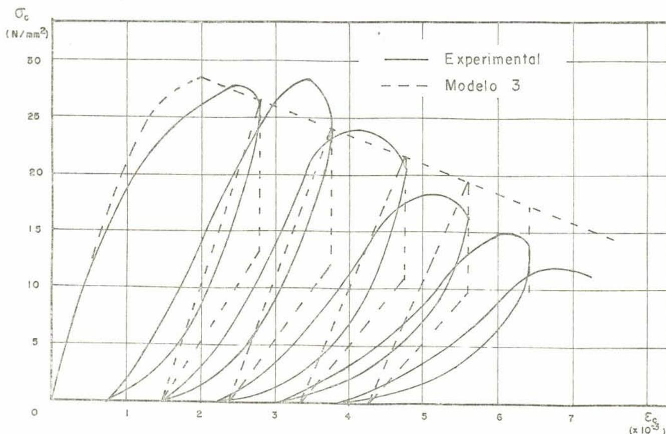
FIGURA 2.2 - Relações T-D para o concreto submetido a carga cíclica
