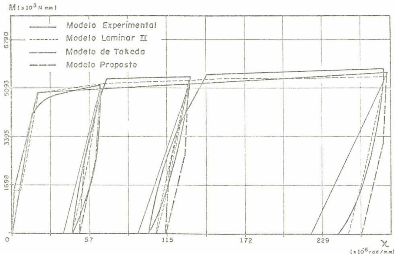
FIGURA 3.7 - Diagrama  $M-\chi$  para a viga 1 submetida a carregamento cíclico.
