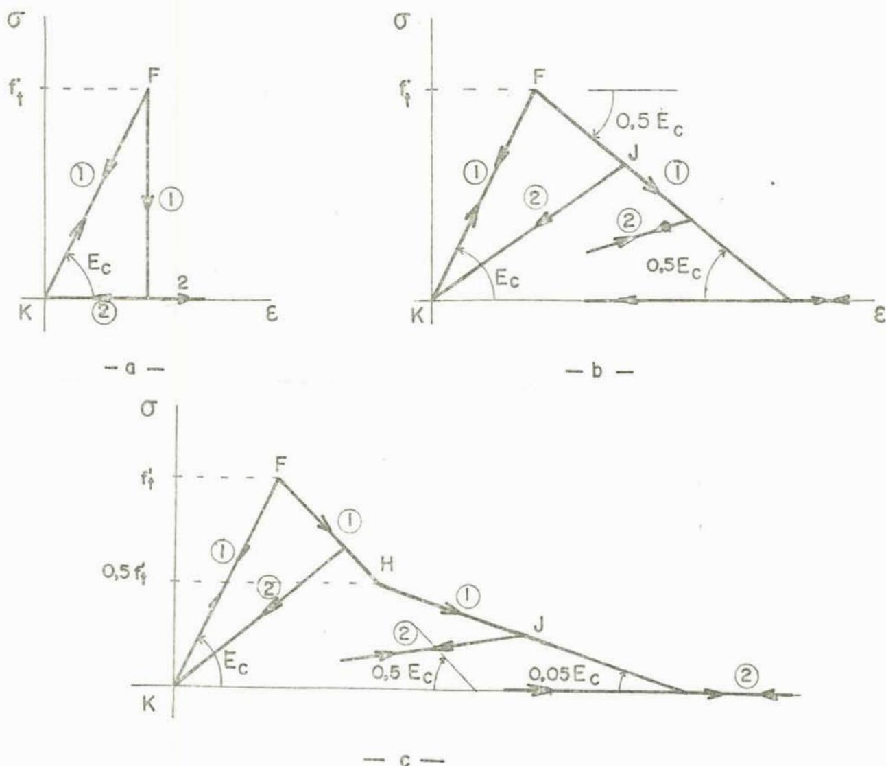
FIGURA 2.3 - Relações T-D para o concreto na tração:
