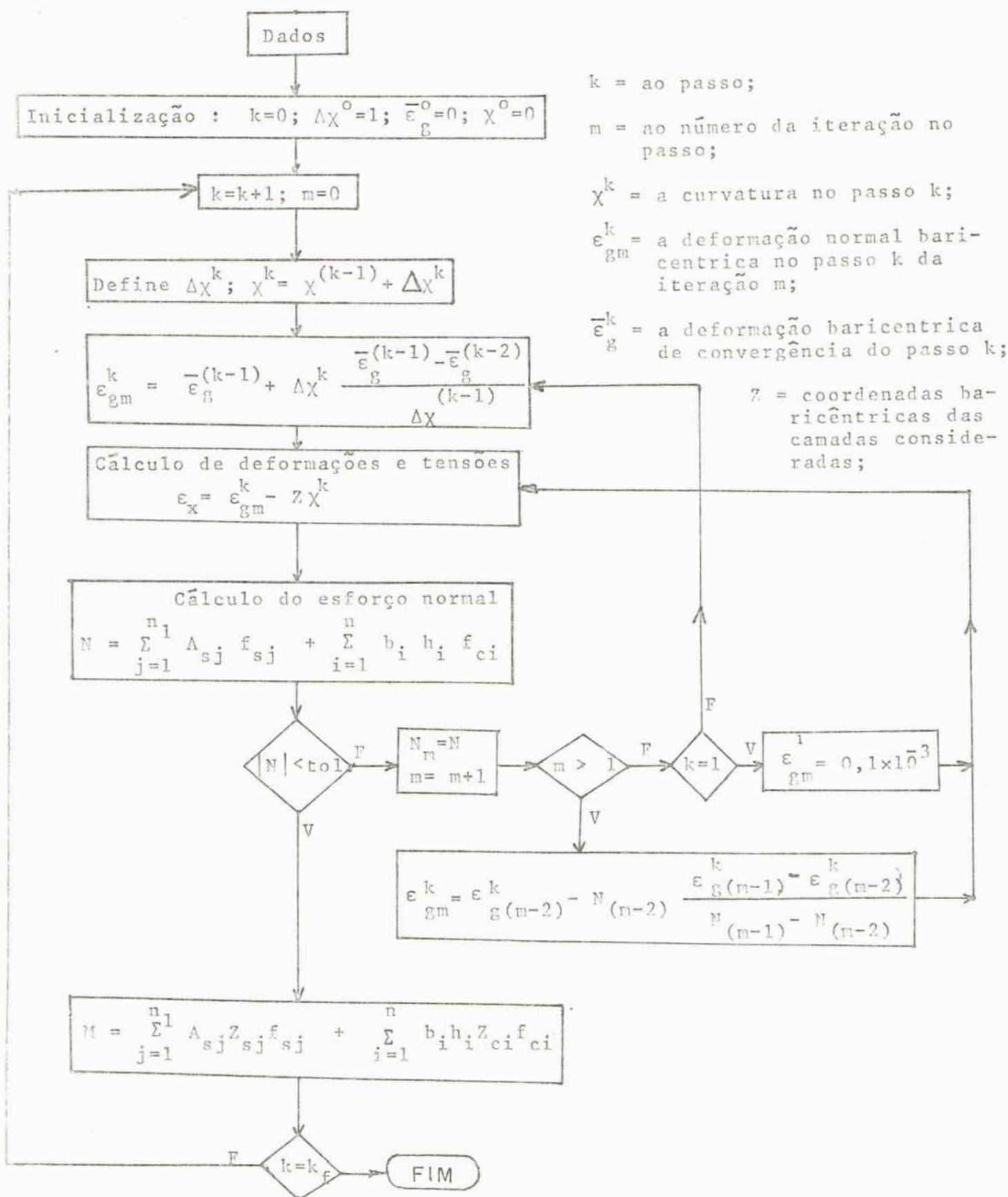
FIGURA 3.3 - Fluxograma detalhado do modelo laminar para o elemento de viga.
