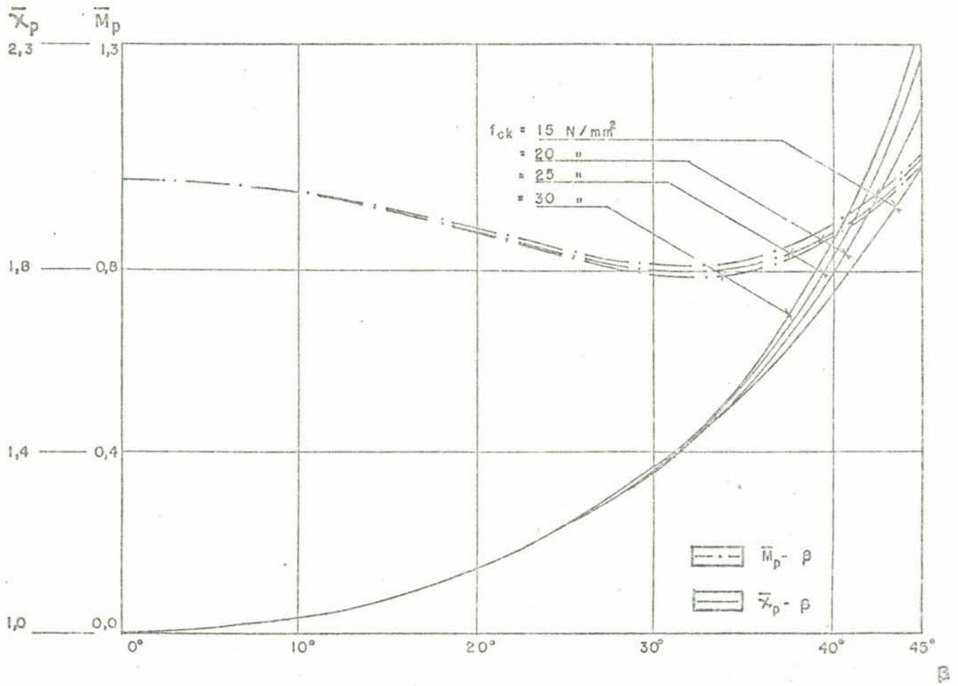
Em geral, os diagramas obtidos pela normalização dos resultados, experimentaram uma influência reduzida ao variar-se os parâmetros  $f_{ck}$ ,  $f_{yk}$ ,  $h$ ,  $\mu$ .
