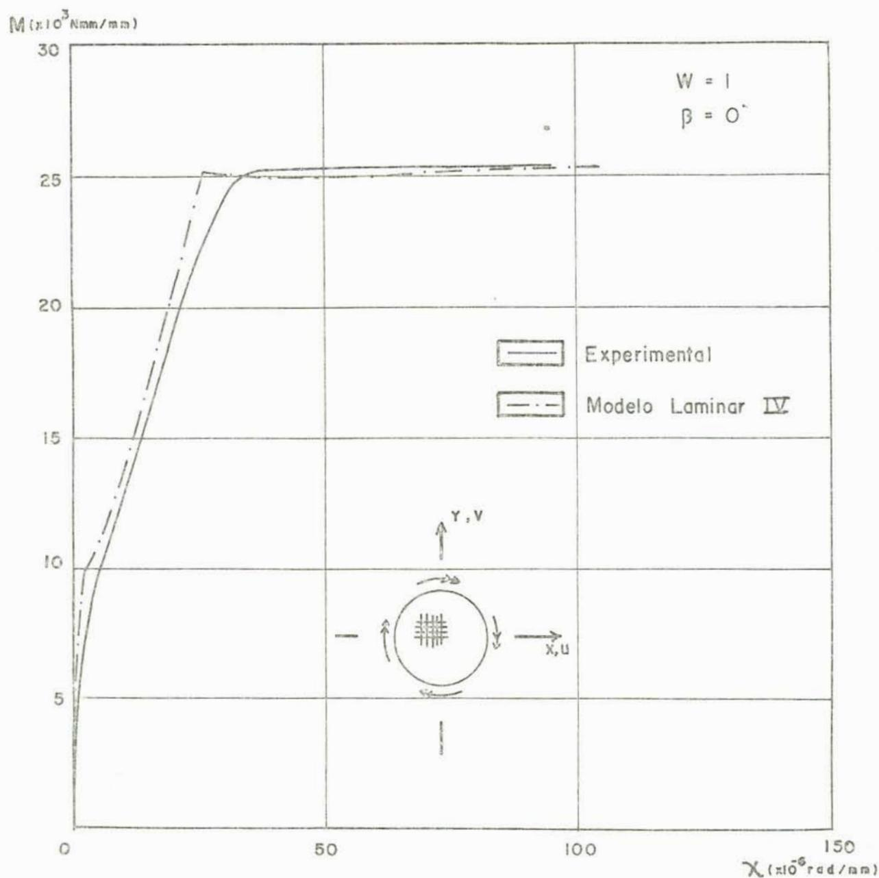
FIGURA 4.5 - Diagrama M- $\chi$  para a laje C2.
