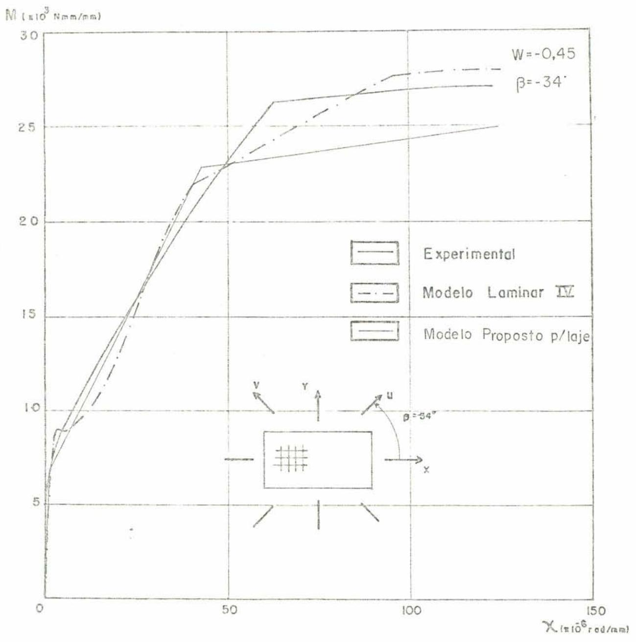
Nas figuras 4.18, 4.19a e 4.19b estão representados os diagramas  $M - \chi$  obtidos experimentalmente, pelo modelo laminar IV e pelo Modelo Proposto Trilinear para lajes. Verifica-se que a aproximação obtida com este modelo em relação ao resultado experimental é boa.
