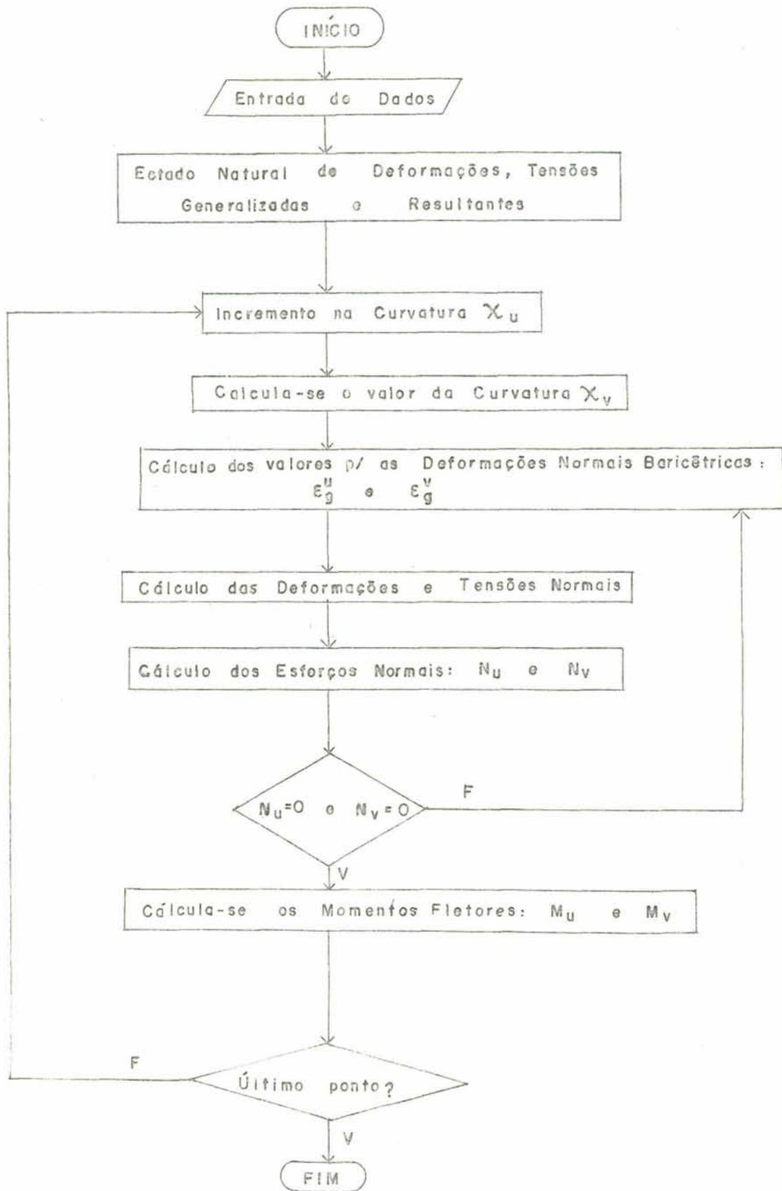
FIGURA 4.3 - Algoritmo do modelo laminar IV para laje de concreto armado.
