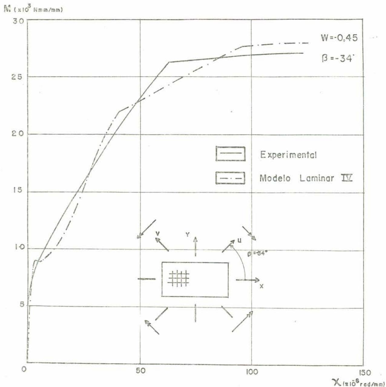
FIGURA 4.7 - Diagrama M-X para a laje B35.
