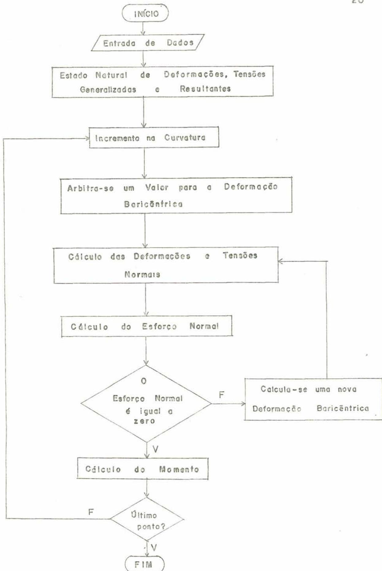
FIGURA 3.2 - Diagrama de bloco do modelo laminar para o elemento de viga.
