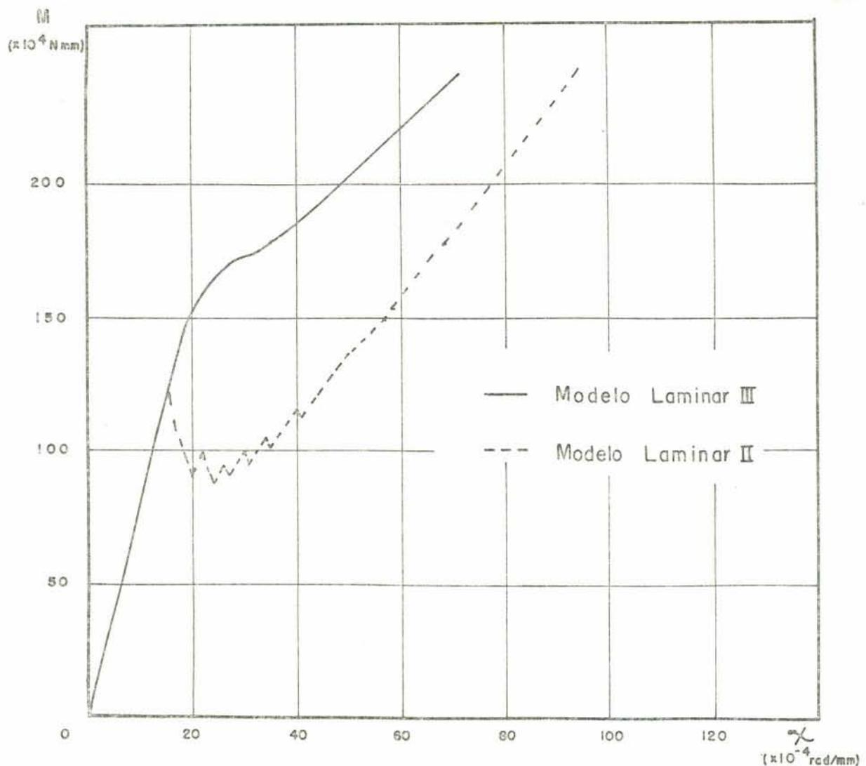
FIGURA 3.10 - Diagrama  $M-\chi$  com diferentes curvas T-D do concreto à tração da Viga 1.
