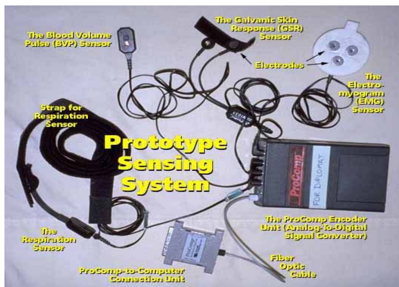
FIGURA 4.1 - Dispositivos conectados ao Thought Technology Procom Encoder Unit
