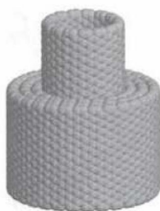
Figura 15. Representação esquemática de um nanotubo de carbono de paredes múltiplas.
