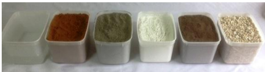
Figura A3.3 – Materiais separados para confecção do isolante térmico (água, areia, cimento, gesso, borracha triturada, EPS triturado).
