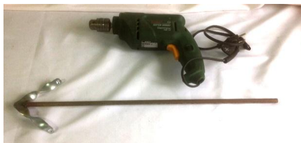
Figura A3.4 – Dispositivo utilizado para auxiliar na mistura do material de recobrimento (isolante térmico).
