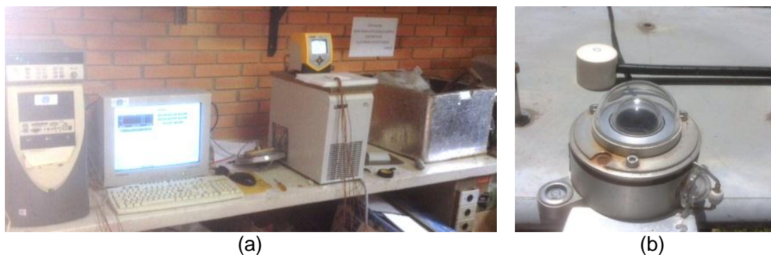
Figura 5.7 – (a) Calibração dos sensores em banho termostático. (b) Calibração do sensor fotossensível, através de comparação direta com o piranômetro.
