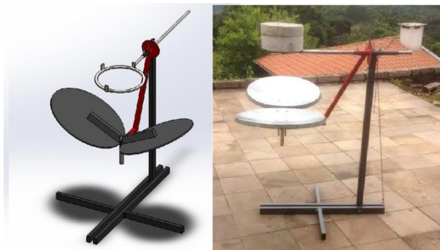
Figura 5.2 – Desenho do fogão em SOLIDWORKS® e projeto executado.
