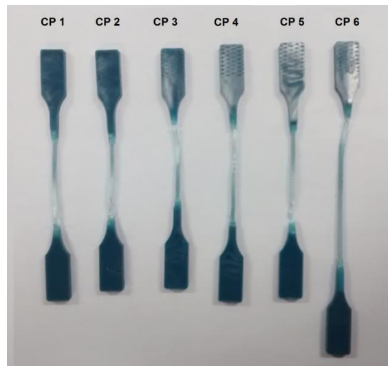
Figura 34 - Corpos de prova PP + carga após a realização do ensaio de tração
