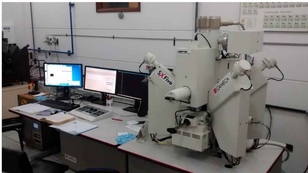
**Figura 23:** Microsonda eletrônica CAMECA modelo SXFive, utilizado nas análises composicionais quantitativas deste trabalho
