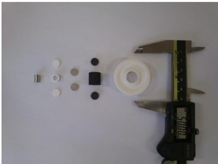
**Figure 8:** Componentes das células de reação, da esquerda para a direita: cápsula de platina, cilindros e tudo de hBN, cilindros de pirofilita, cilindros e tubo de grafite, gaxeta de carbonato de cálcio.
