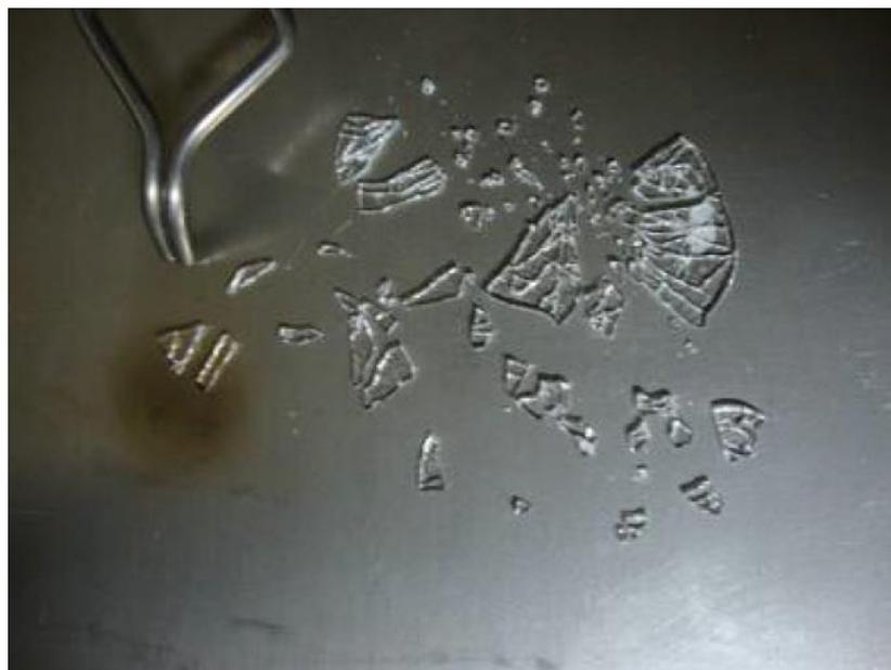
**Figura 14:** Depois de fundidas, as misturas que compõem os vidros são vertidas em chapa INOX, para rápido resfriamento.
