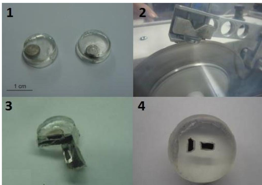
**Figura 21:** Esquema de preparação e corte de cápsulas: 1) Pastilhas contendo as cápsulas processadas; 2) Serra utilizada nos cortes; 3) Pastilhas cortadas; 4) Seção polida preparada para análise em MEV ou microsonda.
