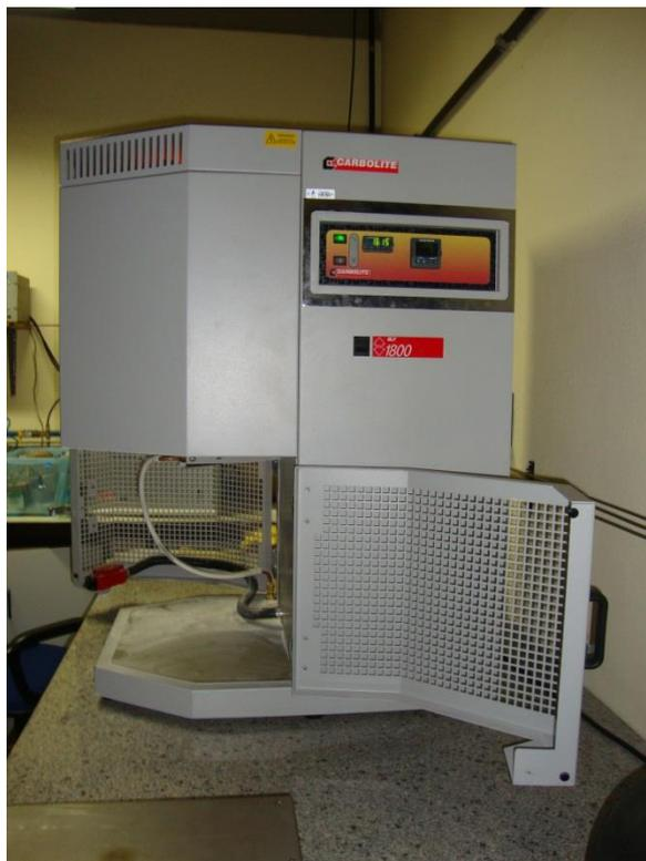
**Figura 12:** Forno da marca Carbolite, utilizado no preparo de vidros.
