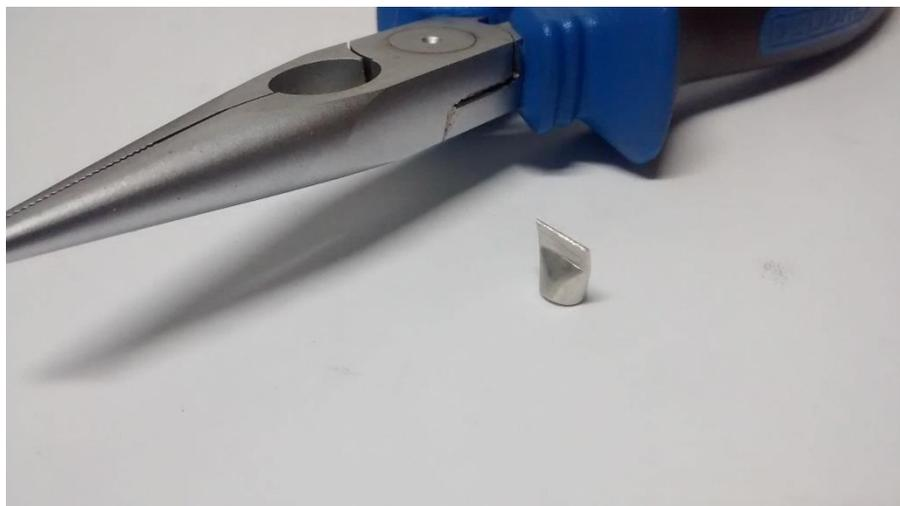
**Figura 16:** Antes com formato de cadinho, as cápsulas de platina foram preenchidas com amostra e fechadas com o auxílio de alicates, para depois serem soldadas.
