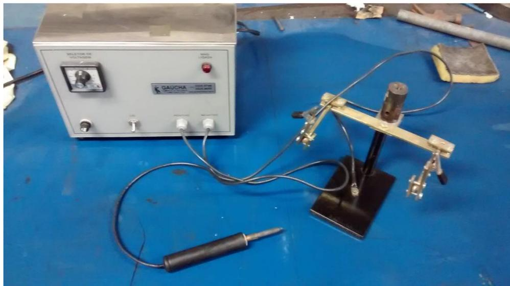
**Figura 18:** Solda utilizada no selamento das cápsulas.
