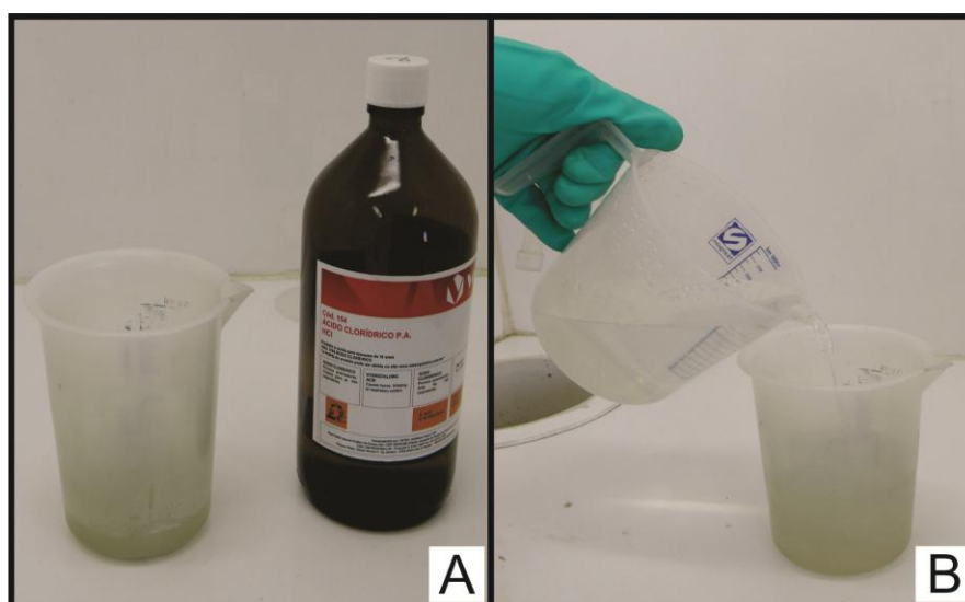
Fig. 16: A) dissolução do material com HCl; B) Preenchimento do béquer com água destilada para a neutralização do ácido.
