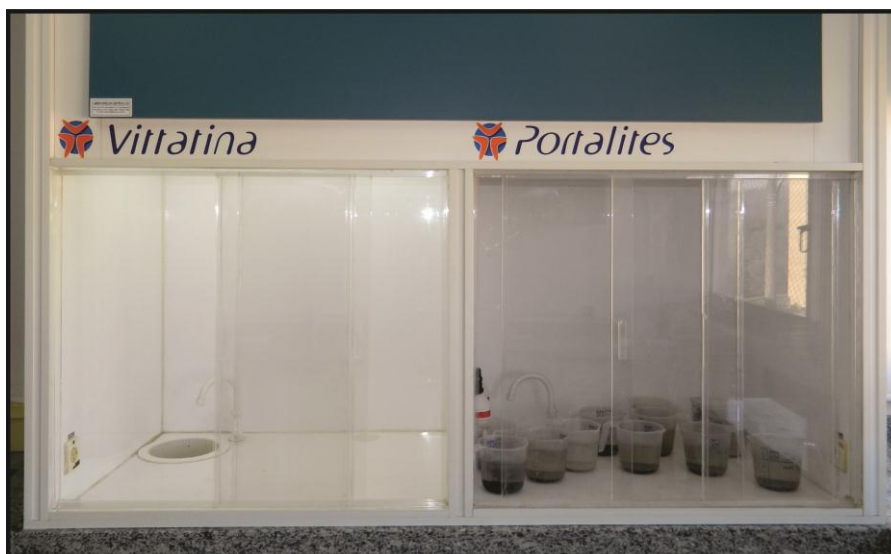
Fig. 15: Capela de exaustão.
