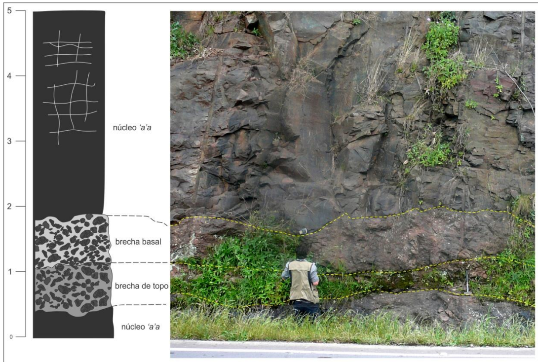
Figura 20 - Contato entre brecha de topo e brecha basal, em derrames do tipo 'a'a.
