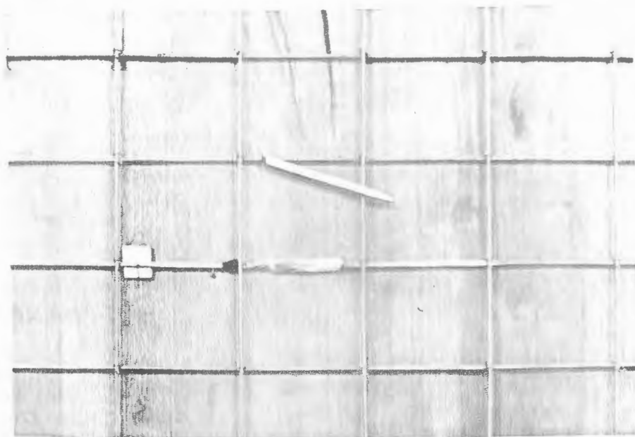
Fig. 3.42 - Barra da armadura instrumentada no protótipo
