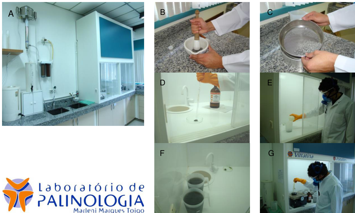
Figura 7 - Etapas para o processamento palinológico das amostras. (A) Capelas do laboratório Marleni Marques Toigo; (B) Moagem das amostras; (C) Peneiramento; (D) Teste com ácido clorídrico; (E) Dissolução das amostras em ácido (F) Diluição em água (G) Dissolução em ácido clorídrico aquecido.
