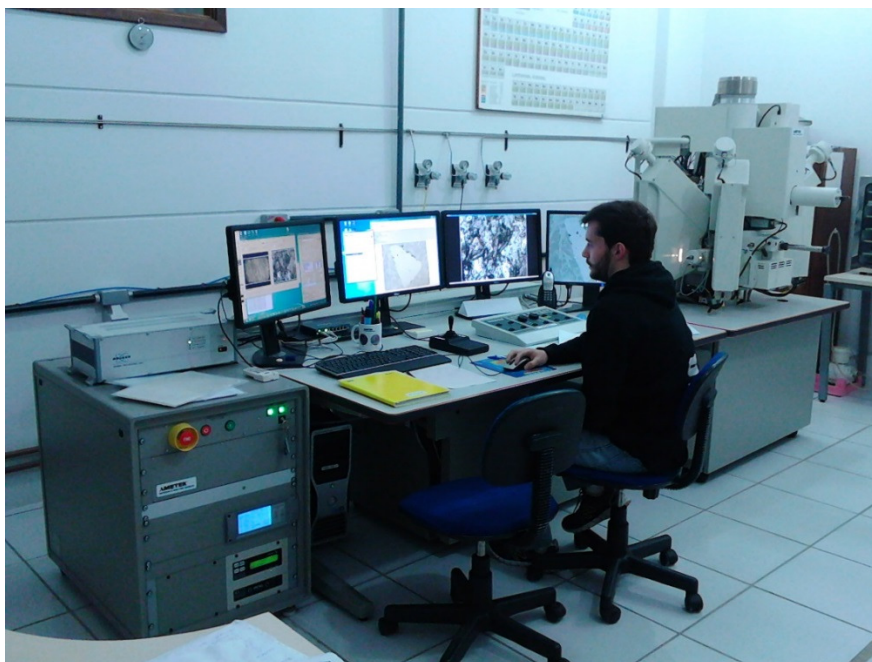
Figura 18. Microsonda eletrônica Cameca SXFive utilizada no estudo. Dados da pesquisa (2015).
