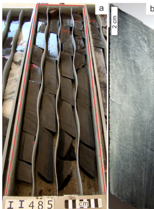
Figura 29. Metagrauwaca. a) Furo de sondagem II-485 com metagrauwaca delimitada pela linha vermelha. b) Amostra de mão de metagrauwaca. Dados da pesquisa (2015).
