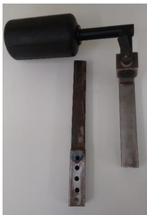
Figura 4. Suporte adaptado para o dinamômetro isocinético para apoio da coxa.
