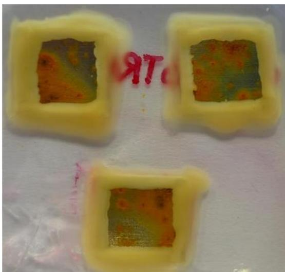
**Figura 54.** Amostras em triplicata da folha de flandres em NaCl 0,05M após 48 horas de imersão.
