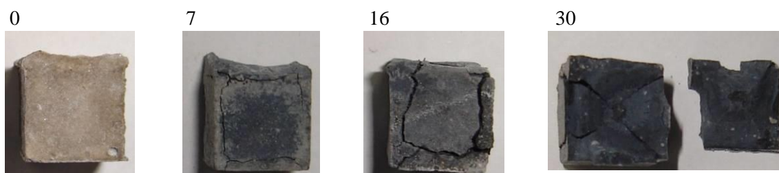
Figura 41 – Cubos de pasta com 25 % de CCA industrial imersos em solução de NaOH aos 0, 7, 16 e 30 dias, respectivamente.
