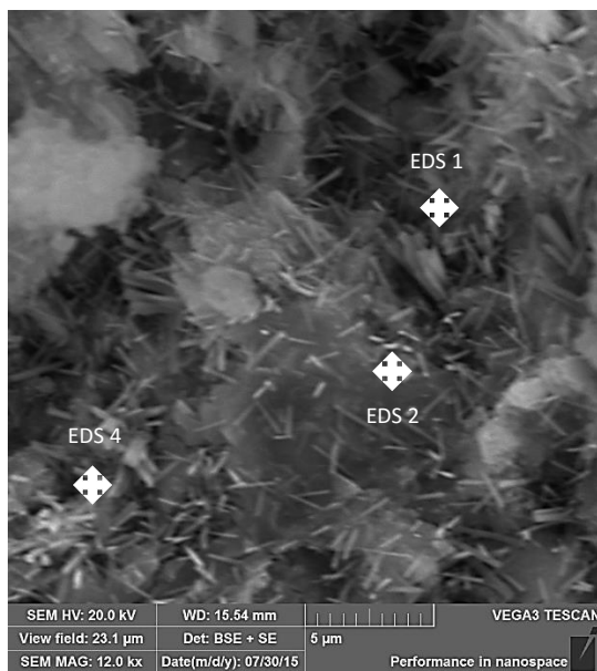
Figura 61 – Micrografia obtida por MEV da amostra extraída da pasta de referência e (a e b), identificação de estruturas aciculares dispersas na superfície pasta, EDS das acículas (c).
