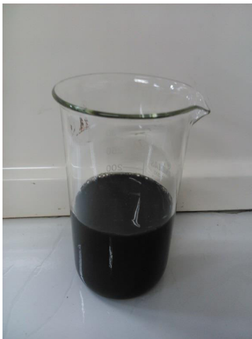
Figura 3.1: Lodo adensado coletado de uma lagoa de aeração de uma estação de tratamento aeróbio de um curtume que utiliza sais de cromo como agente de curtimento.
