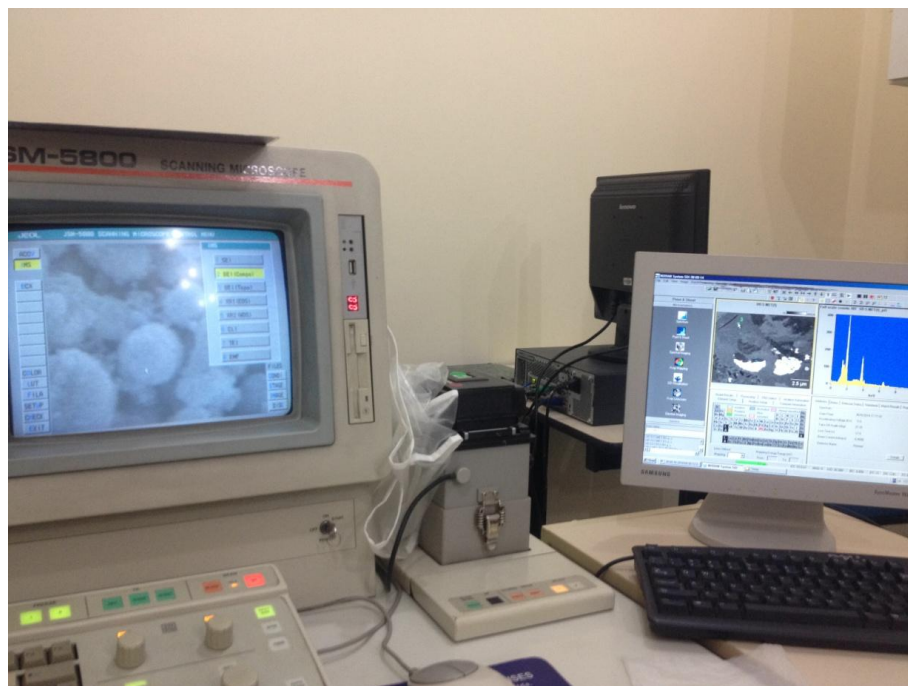
Figura 6: Monitor do microscópio Eletrônico de Varredura do Centro de Microscopia Eletrônica da UFRGS. O modelo usado é o JSM 5800 (Tomada setembro 2014).
