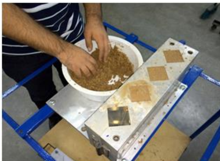
Figura 5 – Colocação do material compósito nas cavidades da matriz
