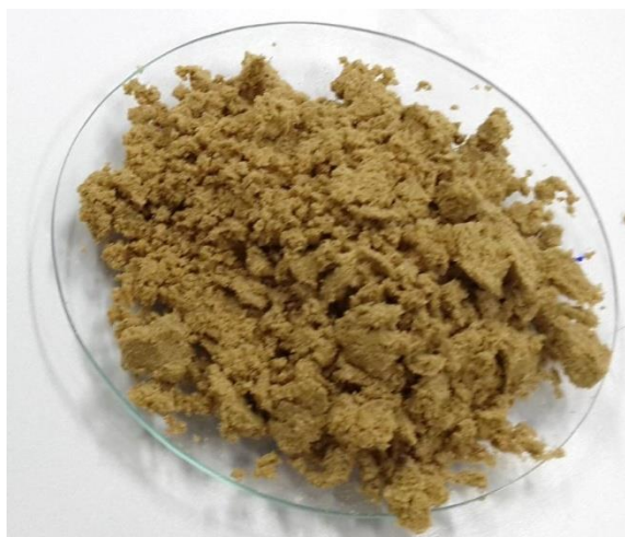
Figura 3 – Pasta mecânica de casca de arroz obtida em refinador Bauer
