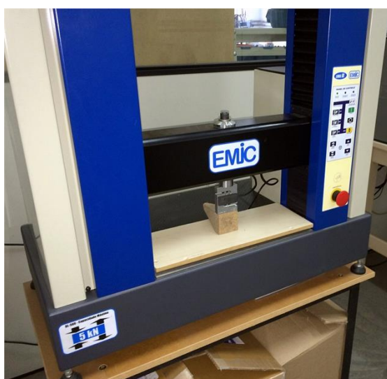
Figura 10 – Amostra do absorvedor piramidal colocada na máquina para ensaio de compressão
