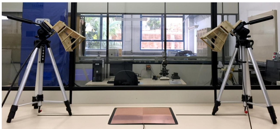
Figura 13 – Aspecto da área de testes com o conjunto de placas refletoras no centro
