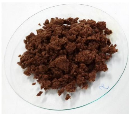
Figura 5 – Polpa de casca de arroz obtida por processo químico tipo sulfato
