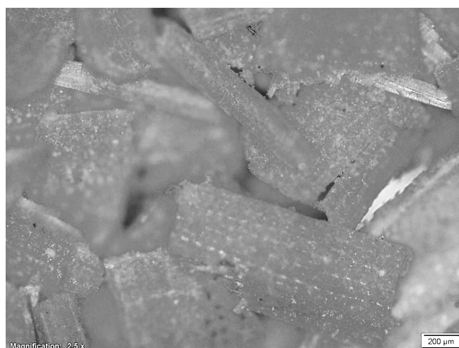
Figura 8 – Análise microscópica da casca de arroz moída
