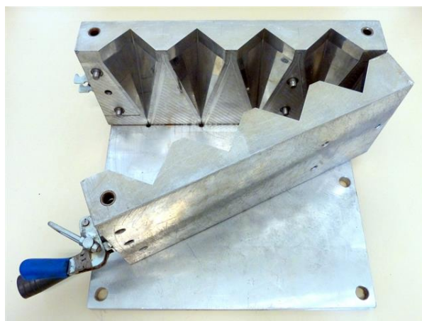
Figura 4 – Vista superior do protótipo do molde desenvolvido para obtenção dos absorvedores piramidais
