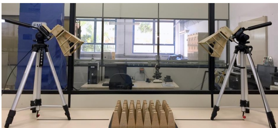
Figura 17 – Aspecto da área de testes com o conjunto de absorvedores piramidais modificados no centro
