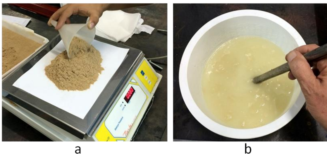
Figura 4 – (a) Pesagem dos materiais; (b) Preparação do amido diluído em água
