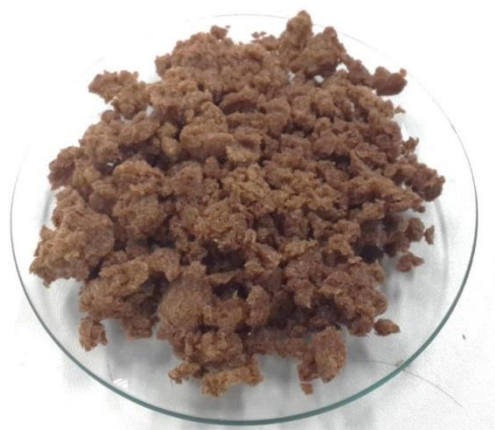
Figura 4 – Polpa de casca de arroz obtida por processo quimomecânico
