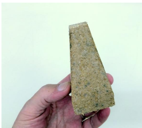
Figura 16 – Protótipo do absorvedor piramidal modificado
