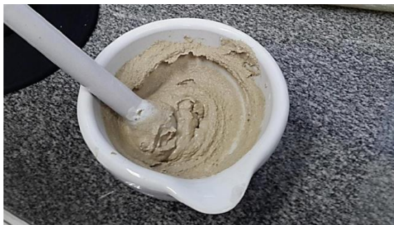
Figura 8 – Mistura de pasta mecânica de arroz e cola branca
