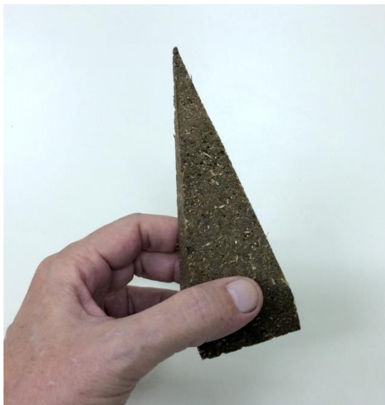
Figura 8 – Protótipo do absorvedor piramidal obtido a partir de um compósito de cascas de arroz moídas e pó de resíduos de MDF
