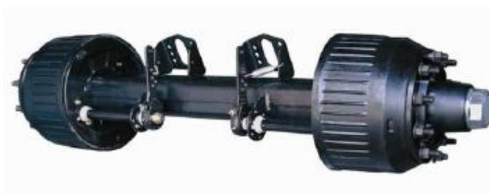
(b) Eixo com sistema de freio acoplado.
