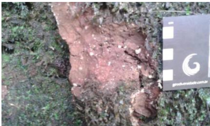
Figura 33. Amostra in loco de rocha de basalto vesicular próximo a parte intermediária da Cascata Wolf 1. Foto: do Autor, em 18/01/2015.
