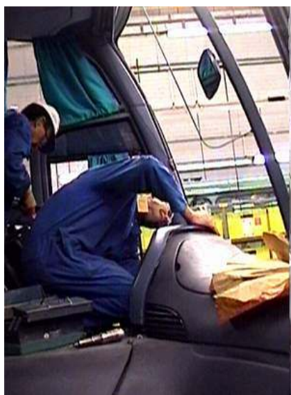
Figura 12. Montagem externa do painel
