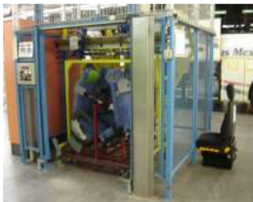
Figura 17 - Transporte de poltronas na fábrica alemã (à esquerda: elevador para transporte desde a área de montagem das poltronas no pavimento superior até a linha de montagem; à direita: trilho de acesso ao interior do veículo)
