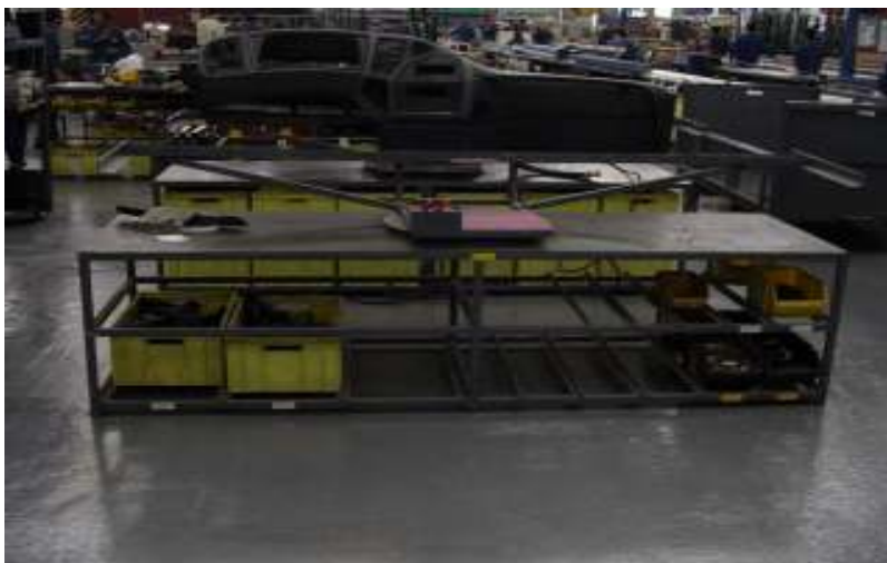
Figura 18 - Bancada testada para a pré-montagem externa do painel
