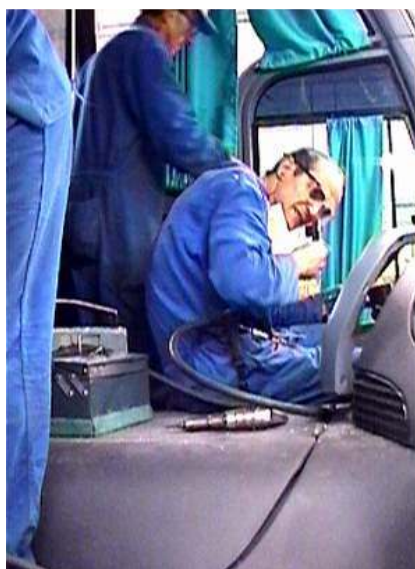
Figura 13. Encaixe da estrutura externa do painel
