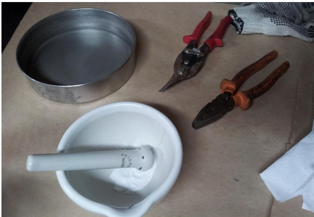
Figura 14: Instrumentos utilizados para moer o vidro frontal dos módulos.
