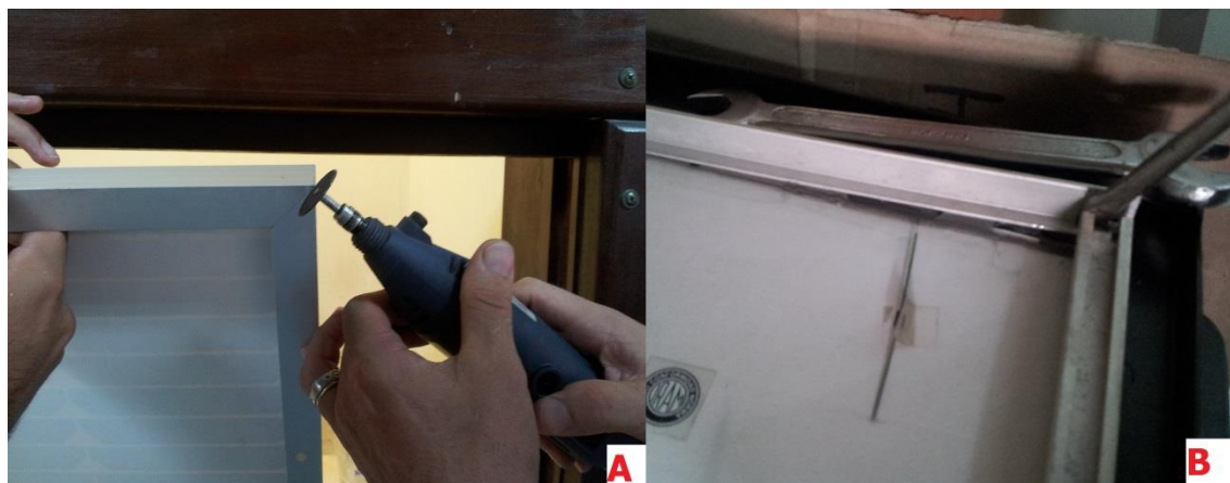
Figura 13: Procedimentos adotados para a remoção da moldura dos módulos. A - Utilização da serra elétrica para cortar moldura. B - Utilização de chaves para separar moldura do restante.
