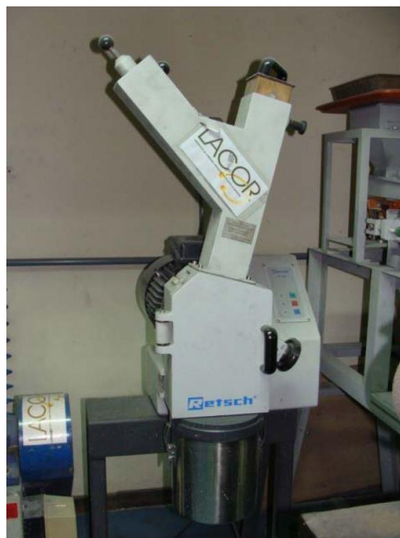
Figura 19: Moinho de facas da marca Retsch, modelo SM2000 utilizado na cominuição.
