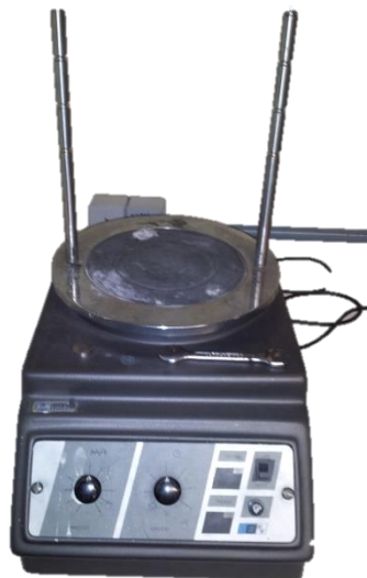
Figura 20: Agitador de peneiras utilizado na separação granulométrica.
