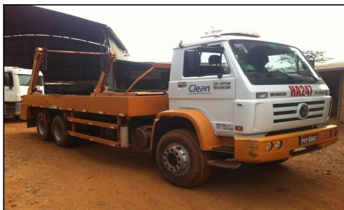
Figura 9 – Veículo coletor poli guindaste duplo
