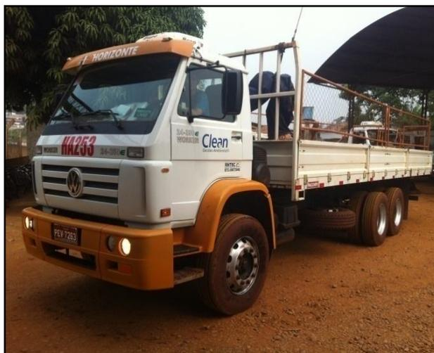
Figura 11 – Veículo coletor de carroceria (carga seca)
