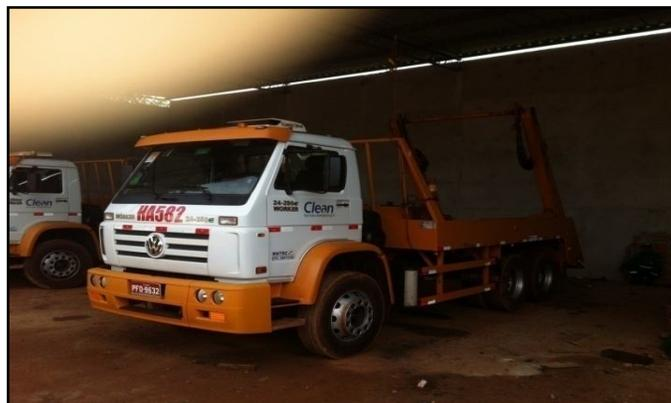
Figura 10 – Veículo coletor poli guindaste simples
