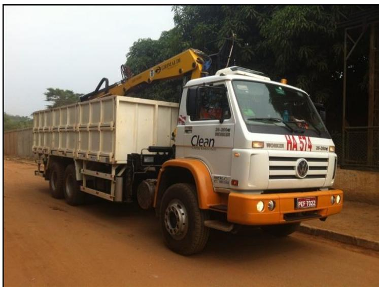
Figura 13 – Veículo coletor garra
