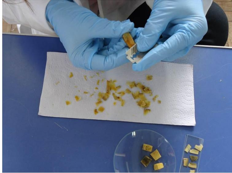
Figura 32: Detalhe do processo de corte das amostras de porongo utilizando lâmina de barbear, após estas terem sido submetidas ao amolecimento por imersão em etilenodiamina 10% durante 48 horas.
