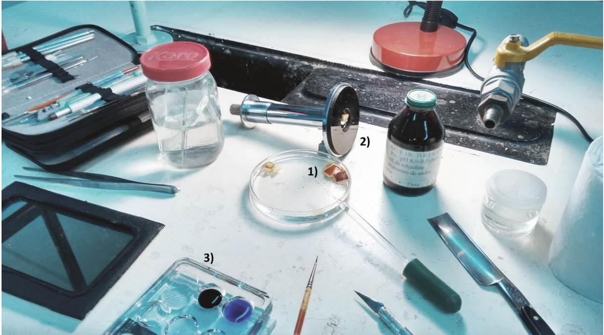
Figura 33: Bancada com os instrumentos utilizados no preparo das lâminas semi-permanentes: 1) Amostras hidratadas; 2) Micrótomo de Ranvier; 3) Placa de Kline para coloração.
