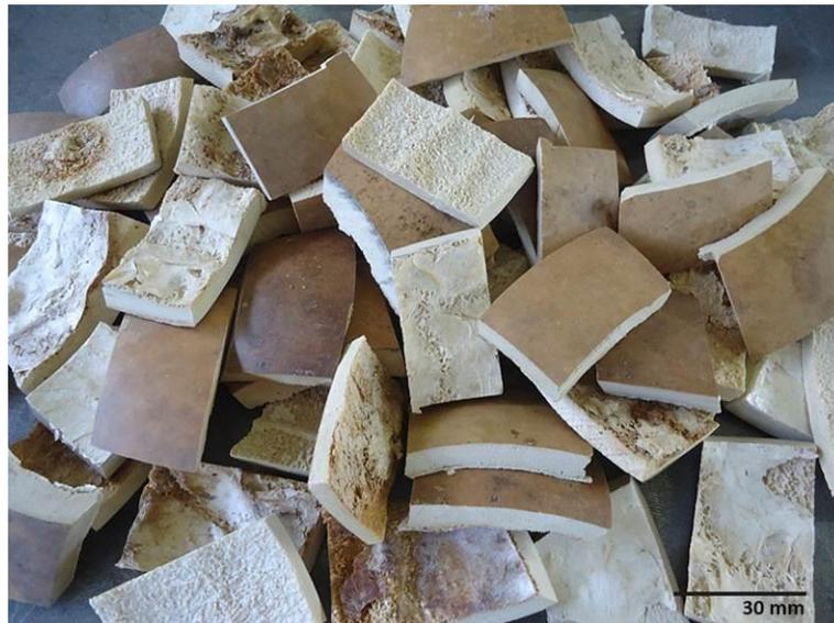
Figura 29: Conjunto de amostras de porongo, após o corte, sem lixamneto da parte interna.
