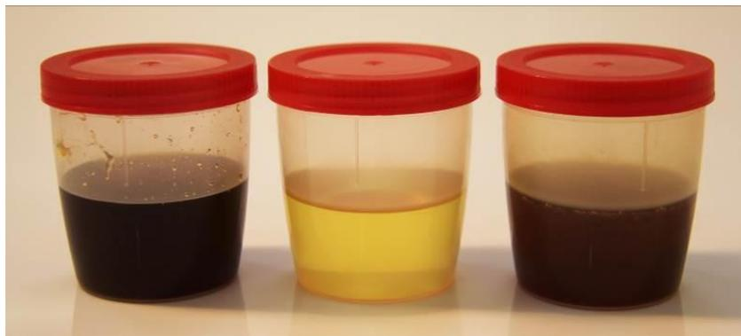
Figura 30: Componentes da resina poliuretana, da esquerda para a direita: componente I (óleo de mamona), componente II e resina bicomponente, após a mistura e polimerização dos componentes I e II.
