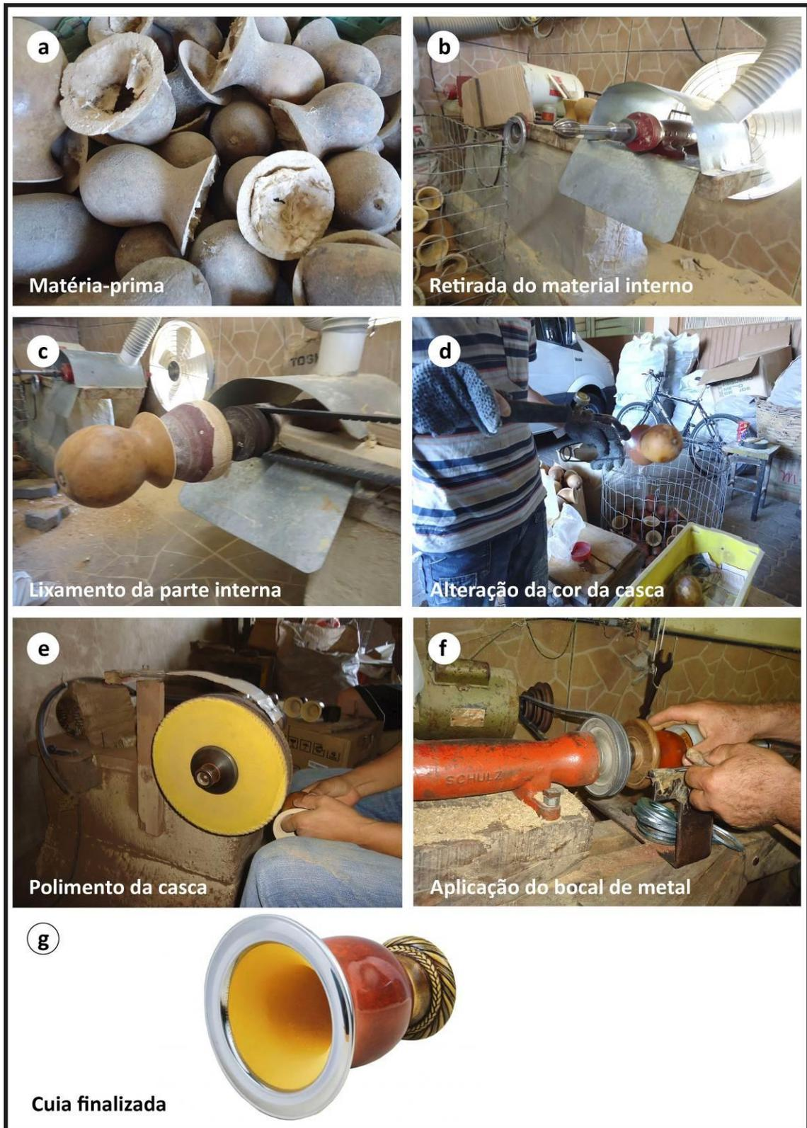
Figura 21: Etapas do processo de fabricação de cuias das empresas visitadas: a) Matéria-prima; b) Retirada do material interno; c) Lixamento da parte interna; d) Alteração da cor da casca; e) Polimento da casca; f) Aplicação do bocal de metal; g) Cuia finalizada.
