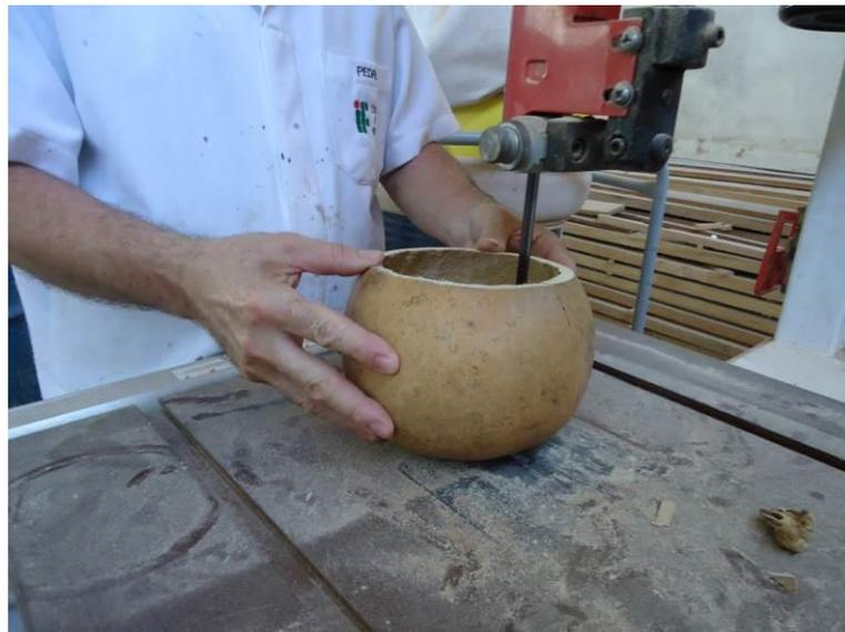
Figura 27: Preparação das amostras: corte longitudinal do fruto na serra tico-tico.
