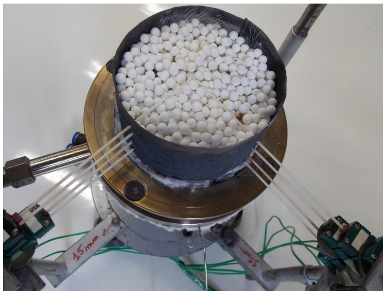
Figura 3.12 – Termopares montados no interior do queimador.
