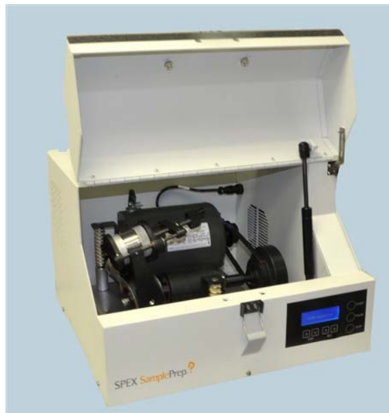
Figura 4.1: Moinho vibratório (SPEX SAMPLEPREP, 2014).
