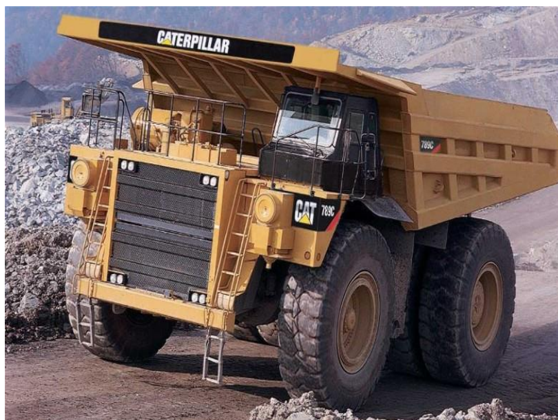
Figura 56. Truck 789C Caterpillar. 1800 HP. Vel. Máxima: 54km/h. Largura: 7.67m
