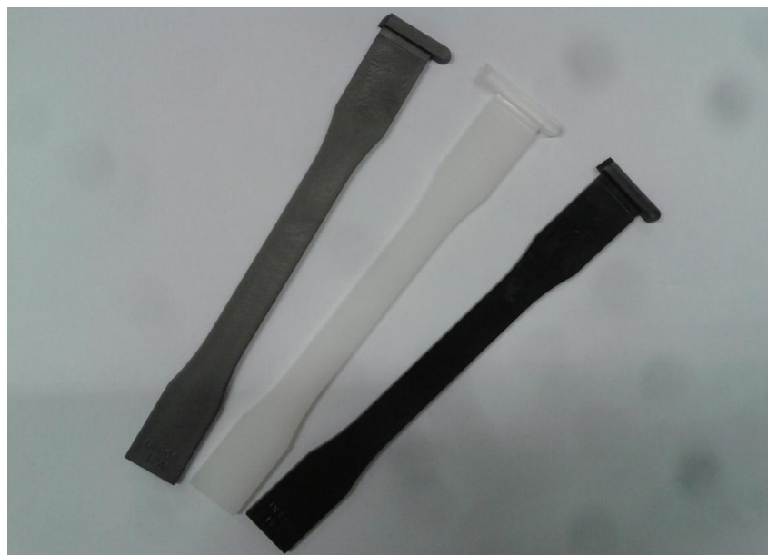
Figura 17. Corpos de prova tipo gravata para obtenção dos corpos de prova para análise da temperatura de deflexão térmica.
