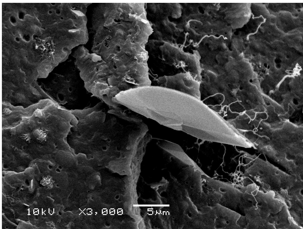
Figura 40. Microscopia eletrônica de varredura para o compósito PPGR2_5 (tamanho médio de partícula de 26,02 µm).
