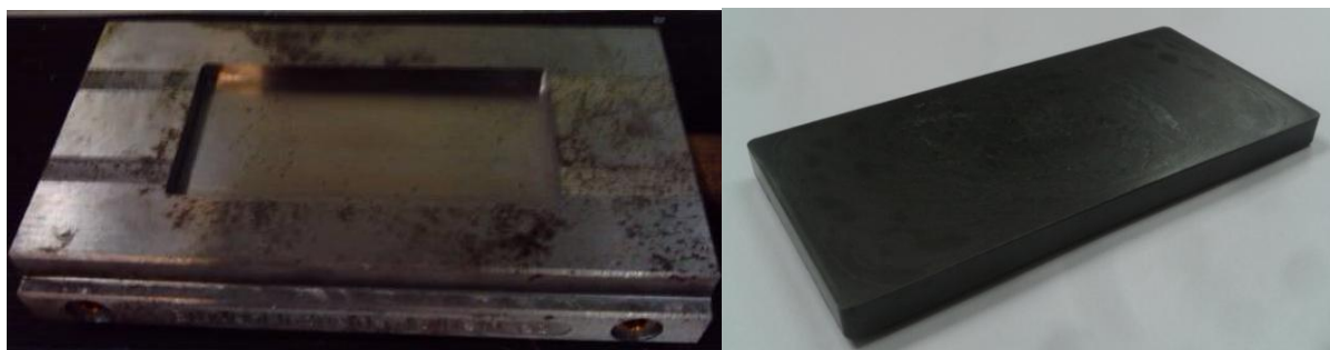
Figura 16. Molde e corpo de prova injetado para análise de condutividade térmica.
