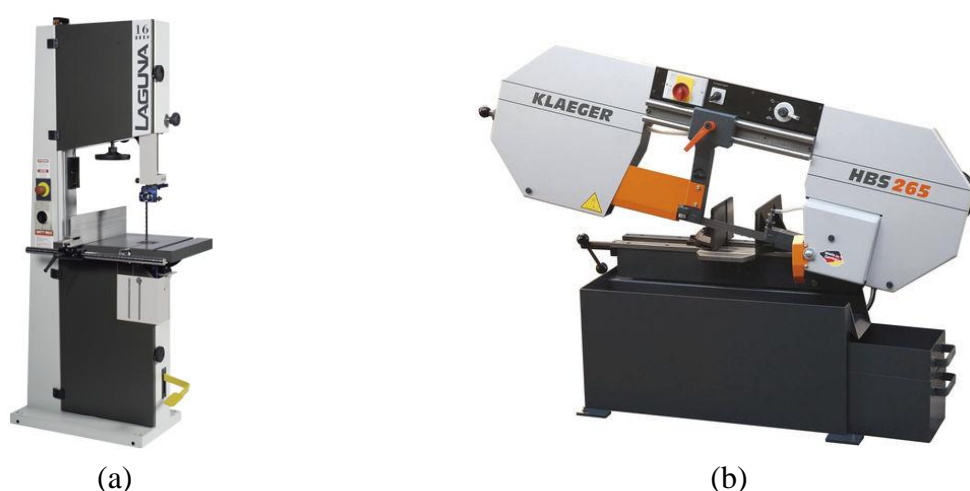
Figura 5.2 – Exemplos de máquinas de serra de fita: (a) vertical [Laguna Tools, 2014]; (b) horizontal [Klaeger, 2014].
