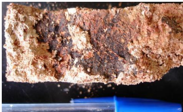
Figura 44: Acúmulo de óxidos em uma descontinuidade no Solo GrVm.
