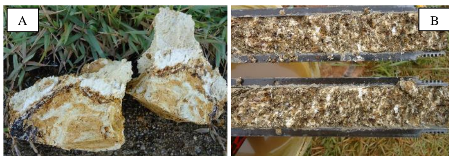
Figura 49: Acumulações de ArBr verificadas em sondagens SPT.
