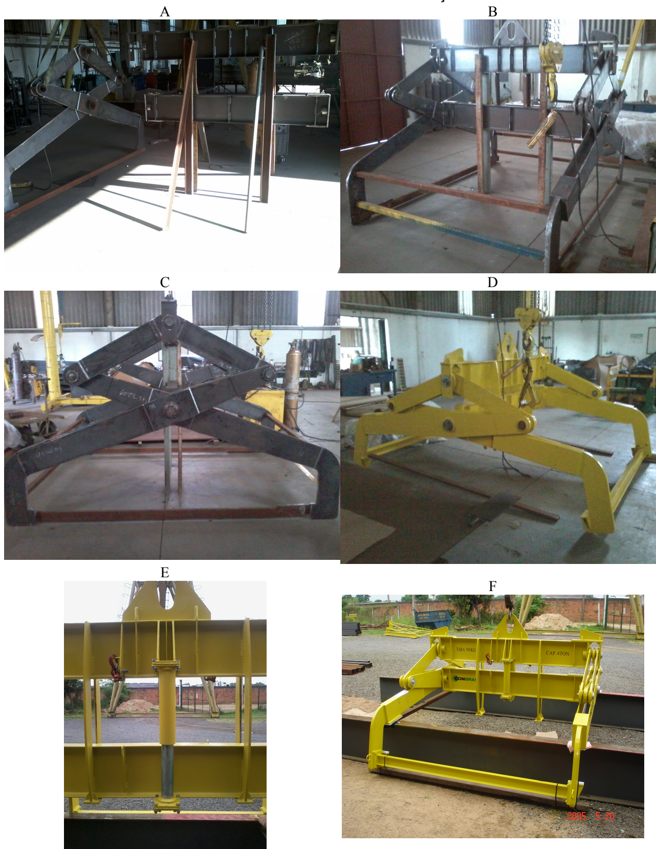
A3.1 – A) Processo de montagem, B) Dispositivo montado, C) Mecanismo articulado, D) Pintura do manipulador, E) Sistema de trava automática instalado e F) Teste funcional do protótipo
