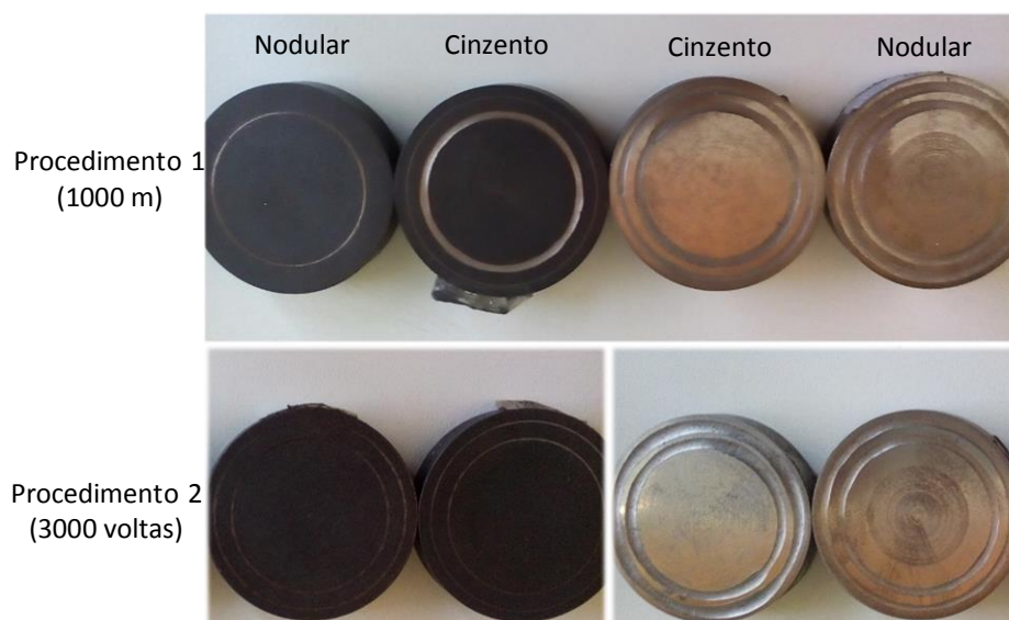
Figura 5.4 - Corpos de prova metálicos pós ensaio
