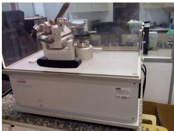
Figura 4.2 - Elementos de um ensaio seguindo a norma ASTM G99. (Fonte ASTM G99, 2000)
