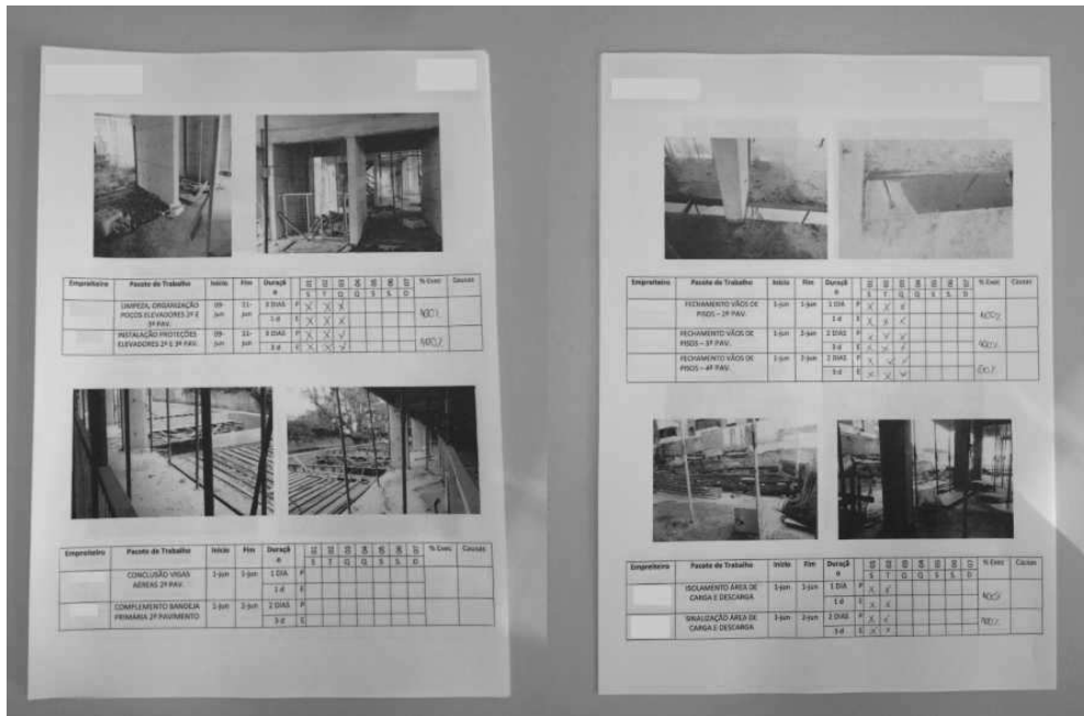
Figura 42 – Planejamento dos pacotes de segurança na obra J2
