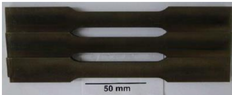
Figura 51 – Corpos de provas utilizados no ensaio de tração
