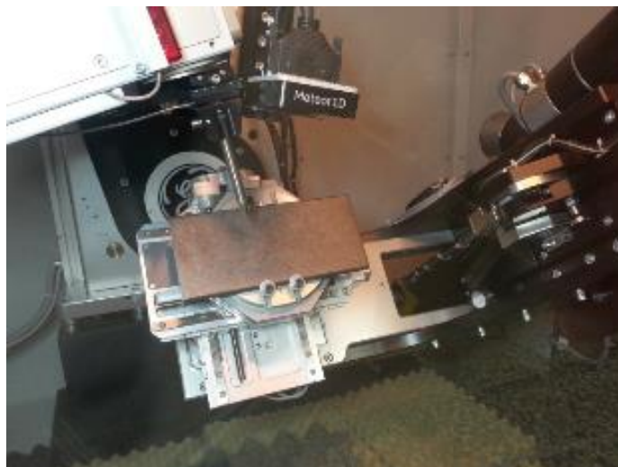
Figura 40 – Representação típico equipamento para medição por difração por raios-X
