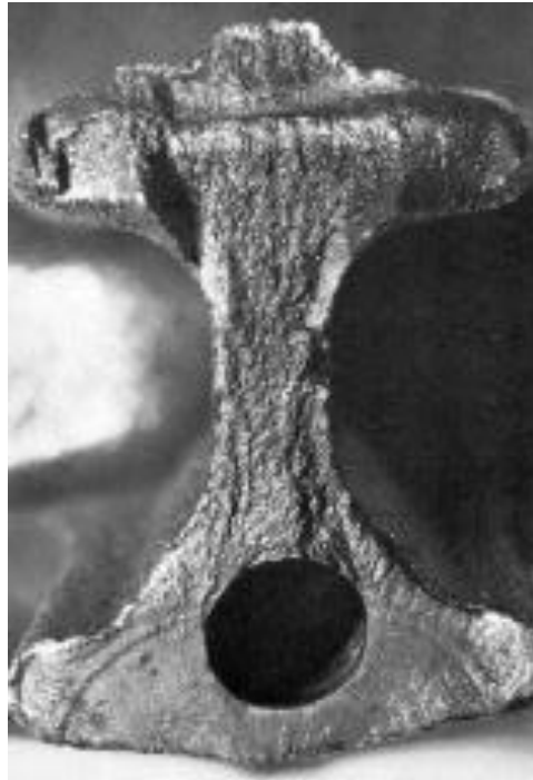
Figura 6 – Superfície de fratura por fadiga de uma barra conectora forjada de aço AISI 8640. As marcas de praias podem ser observadas na parte inferior da peça
