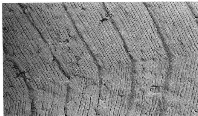
Figura 3 – Estrias de fadiga devido a sequência variada da amplitude de carregamento
