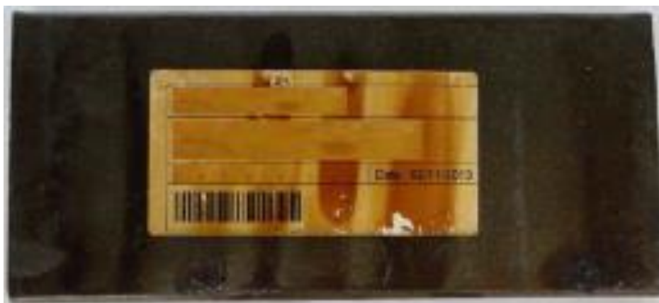
Figura 47 – Amostra material aço SAE 5160 com identificação da face submetida à shot peening
