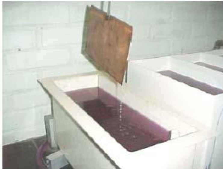
Figura 8 - Otimização da forma de pendurar as peças. Fonte: COMPANHIA PERNAMBUCANA DO MEIO AMBIENTE, 2001.
