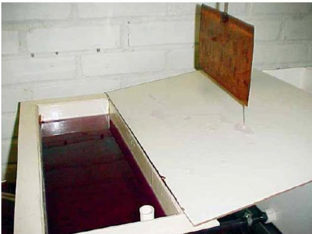
Figura 10 - Rampa de respingos redirecionando o fluxo de volta ao tanque. Fonte:COMPANHIA PERNAMBUCANA DO MEIO AMBIENTE, 2001.
