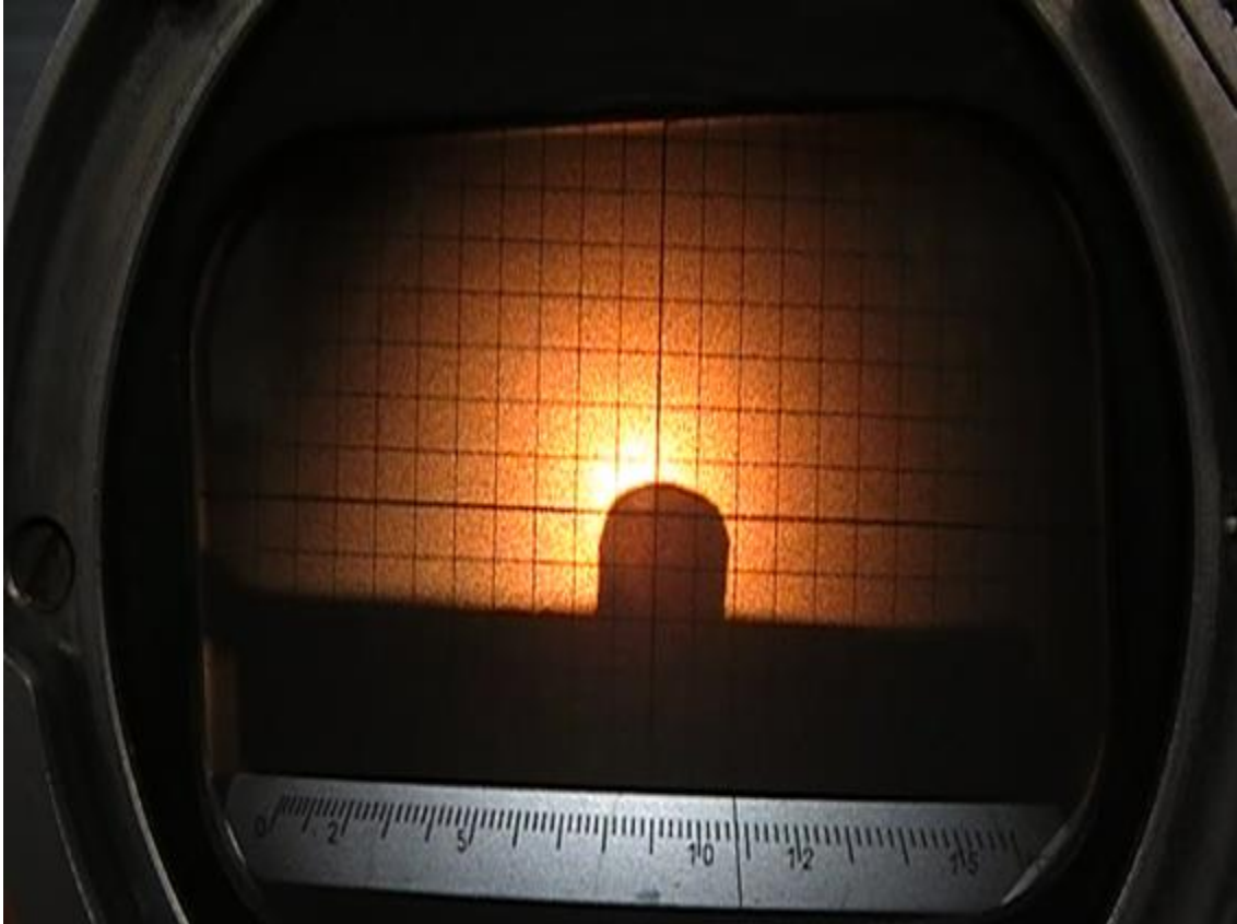
Figura 54 – Temperatura de esfera – Ensaio no microscópio de aquecimento, T = 1090^{\circ}\text{C} .
