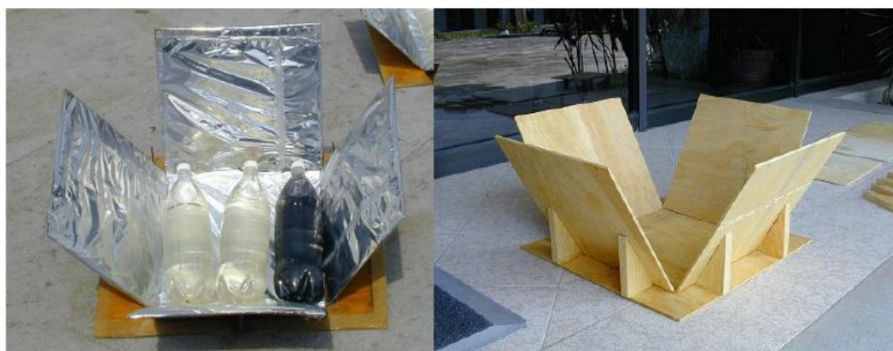
Figura 3.13: Modelo de Concentrador Solar proposto pelo Instituto Mexicano de Tecnologia de Água
