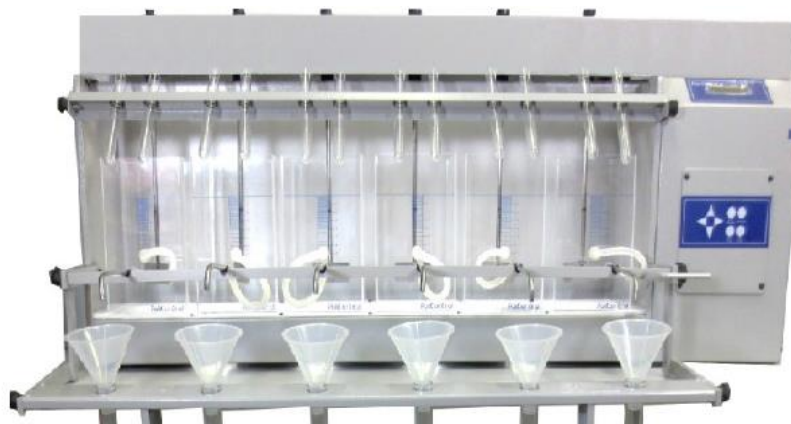
Figura 4.6: Equipamento de Reatores Estáticos, modelo FlocControl III
