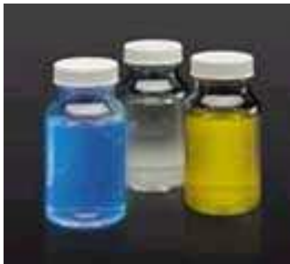
Figura 3.2: Mudança de coloração na reação enzimática ONPG/ MUG (Idexx, 2013)
