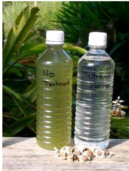
Figura 3.10: Frascos de água não tratada (à esquerda) e tratada (à direita) com Moringa (fonte: www.moringatrees.org )
