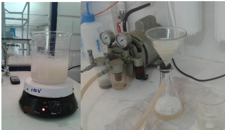
Figura 4.4: Extração e filtração do composto ativo da M. oleifera : à esquerda agitador magnético e à direita bomba a vácuo
