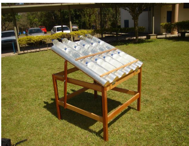
Figura 4.7: Aparato para apoio de garrafas expostas ao SODIS
