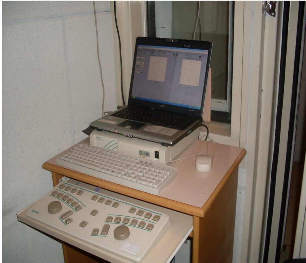
Figura 15. Equipamento Unity PC (Siemens) utilizado na realização de audiometria convencional e de frequências ultra-altas de 125 Hz a 16000 Hz.
