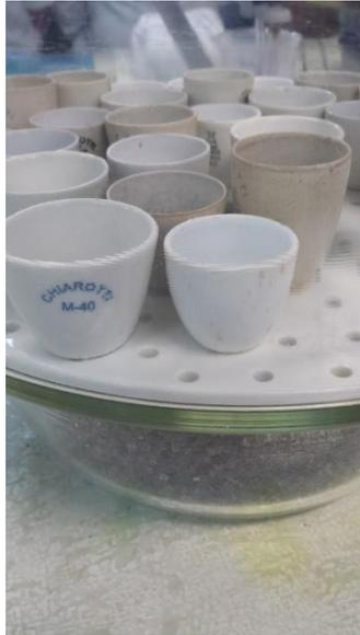
**Figura 3 - Amostras acondicionadas em dessecador.**
