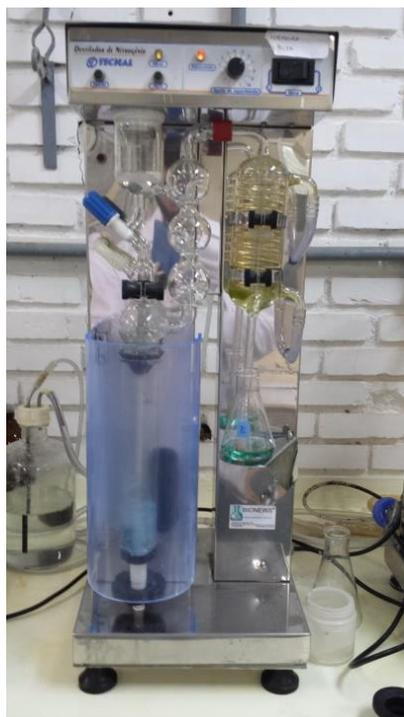
**Figura 2 - Destilador de nitrogênio utilizado no método de Kjeldahl.**
