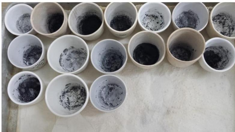
**Figura 5 - Cadinhos com cinzas depois de retirados da mufla.**
