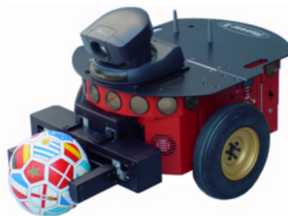
Figura A.6: Fotografia do Pioneer 3-DX. Fonte: (MOBILEROBOTS, 1995–2006)
