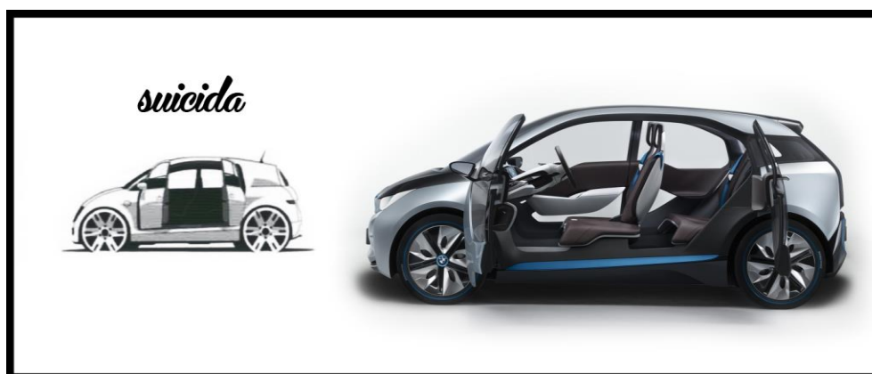
Figura 46: Abertura lateral com articulação frontal e articulação traseira
