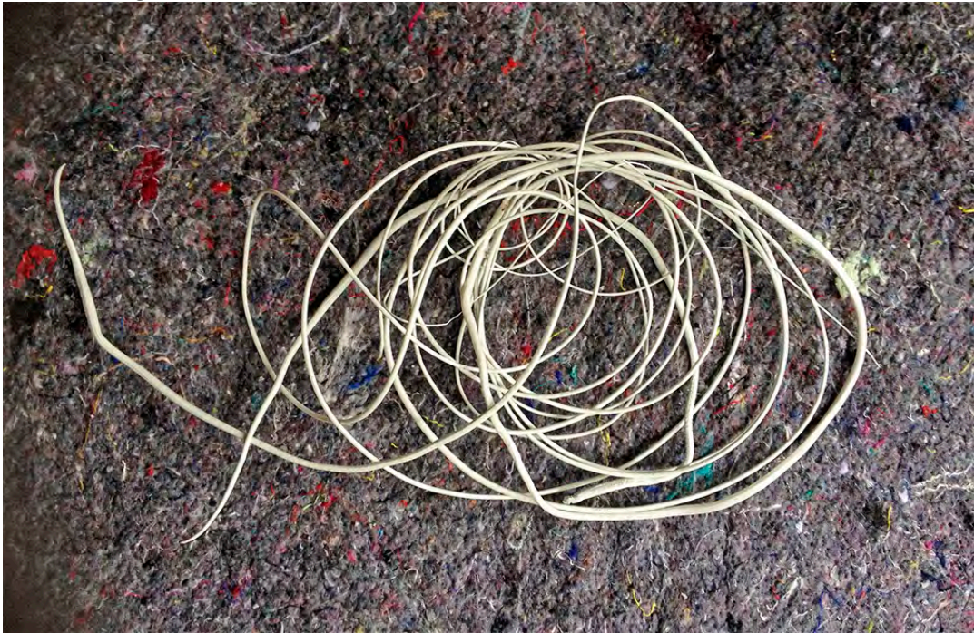
Figura 40 – Filamento obtido na primeira sessão de extrusão no LAPOL
