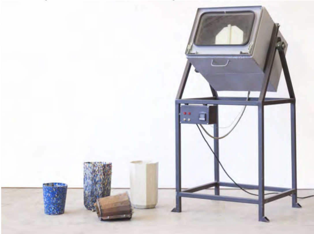
Figura 68 – Equipamento de Rotomoldagem do Projeto Precious Plastic
