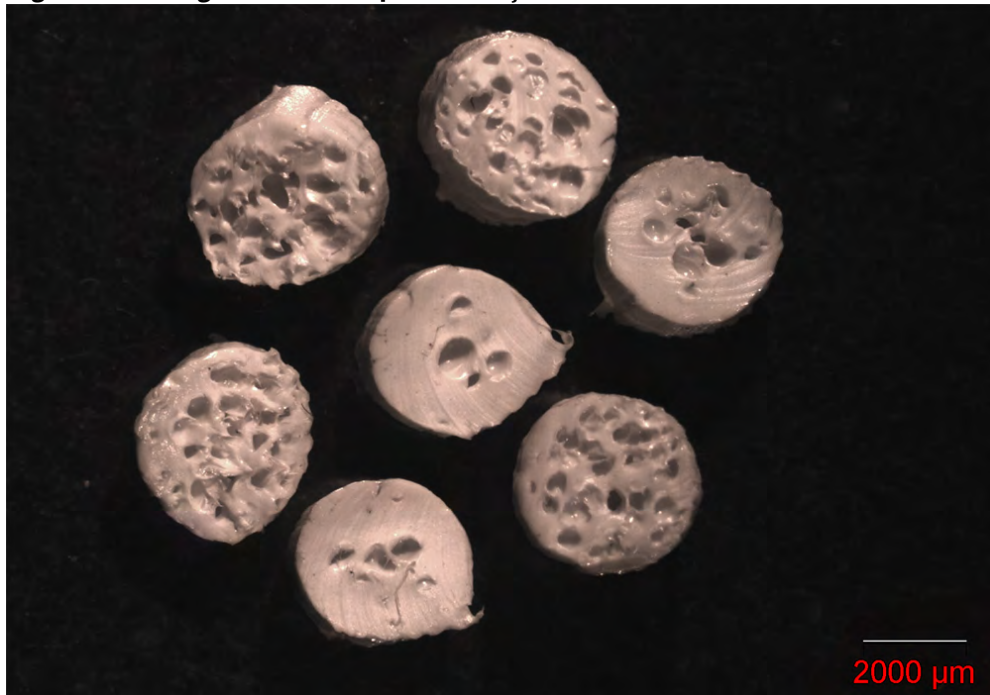
Figura 43 – Fotografia microscópica de secções transversais do filamento extrusado
