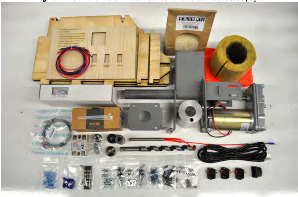
Figura 76 - Uma extrusora Filabot Wee desmontada com todas suas peças
