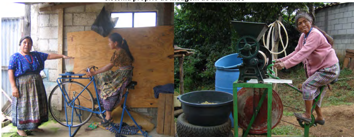
Figura 71 – Da esq. para a dir.: “bicimáquina” que opera um liquidificador e “bicimáquina” com sistema próprio de moagem de alimentos
