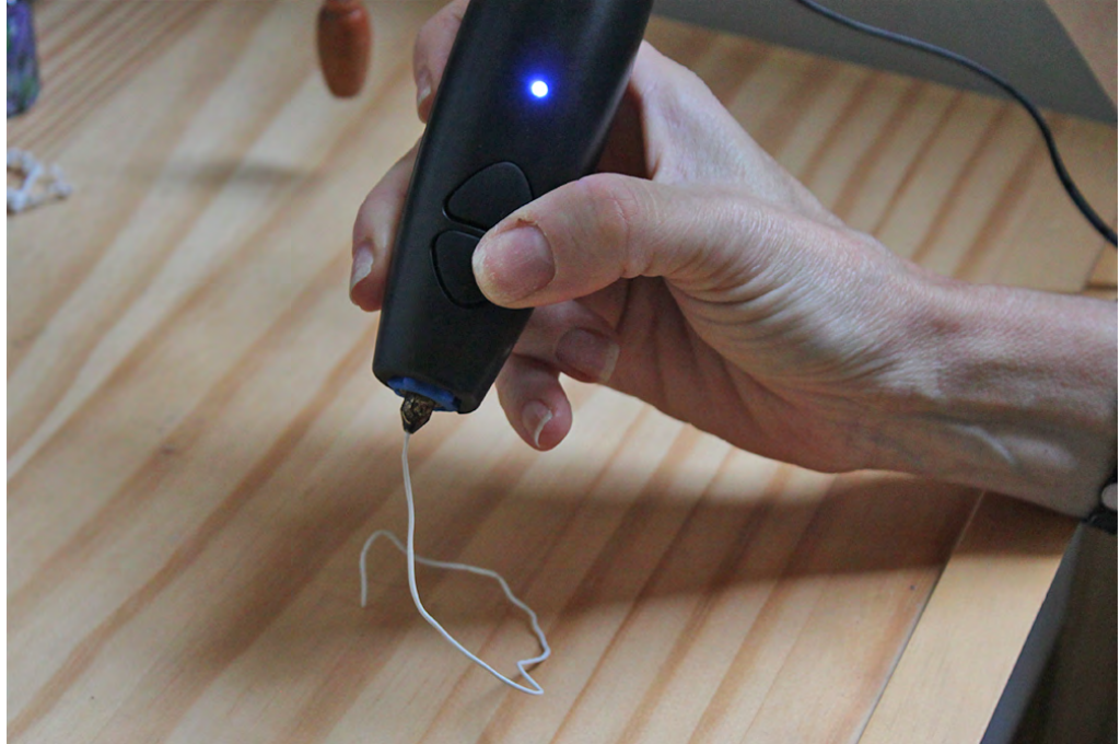
Figura 52 – Filamento obtido pela extrusão de sacola plástica (PEAD) sendo utilizado na Caneta 3D
