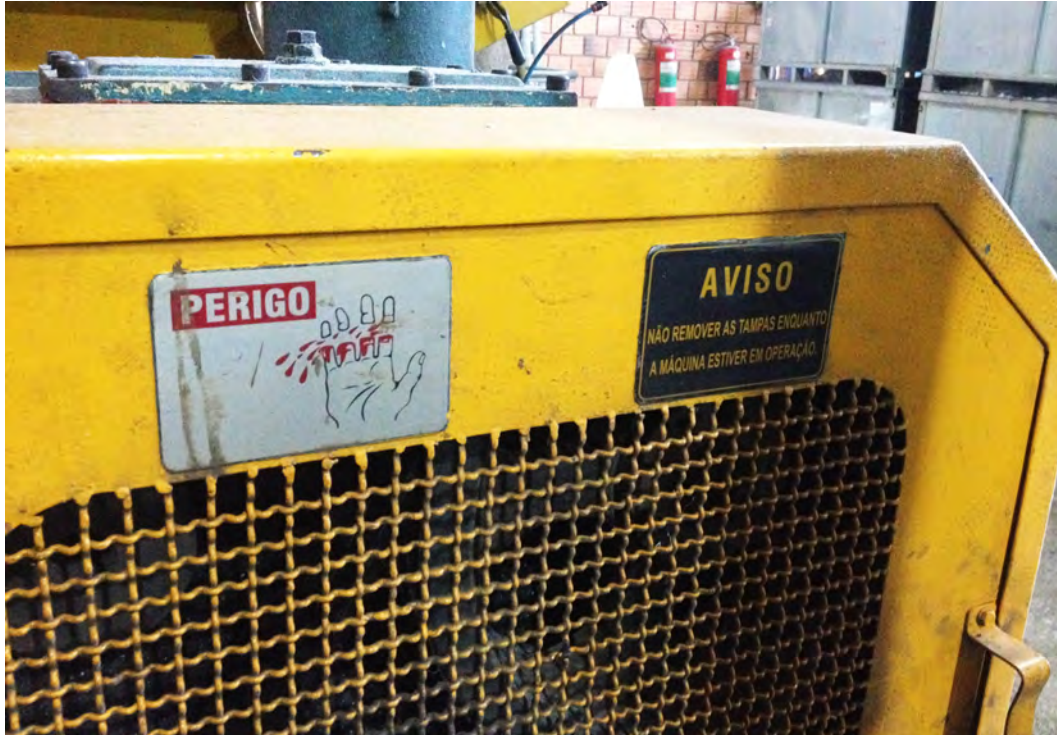
Figura 13 – Avisos de Segurança na Extrusora da Valimplast
