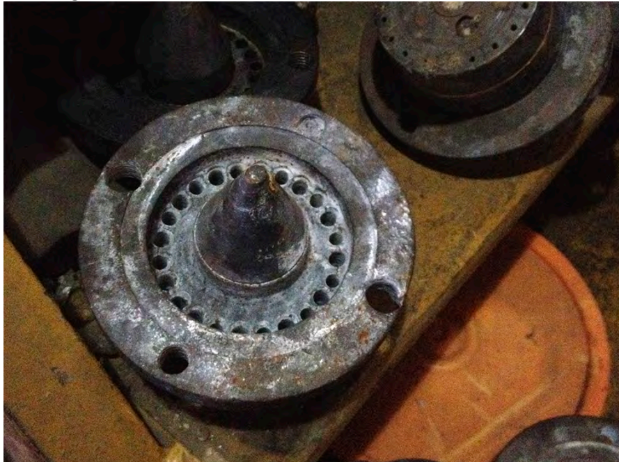
Figura 12 – Matrizes cambiáveis desenvolvidas pela Valimplast.
