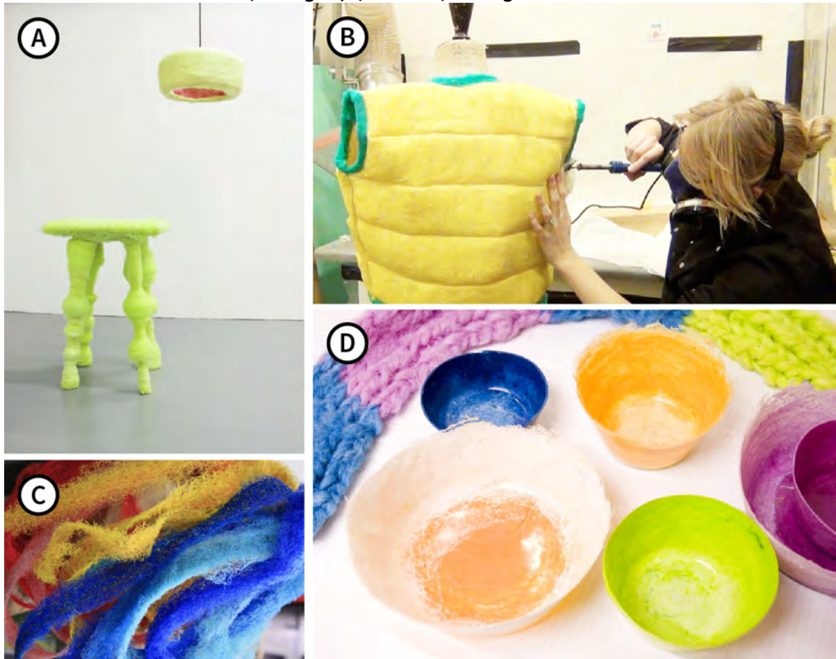
Figura 66 - Testes de aplicação e técnicas de pós-produção do Polyfloss : a) revestimento, b) soldagem, c) fibras e d) moldagem e tricô.
