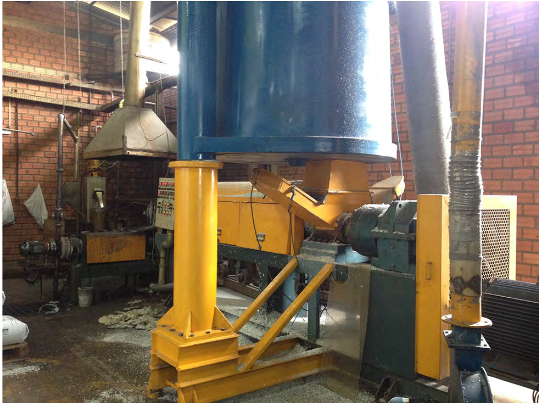
Figura 10 - Extrusora em Cascata da empresa recicladora Valimplast.
