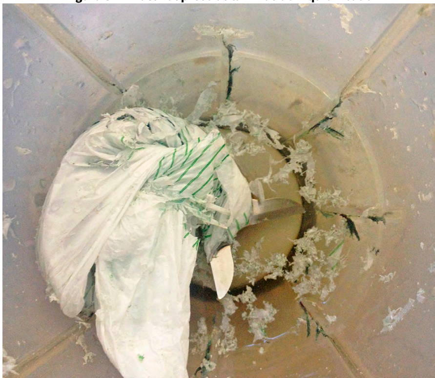
Figura 34 - Material preso às lâminas do Liquidificador
