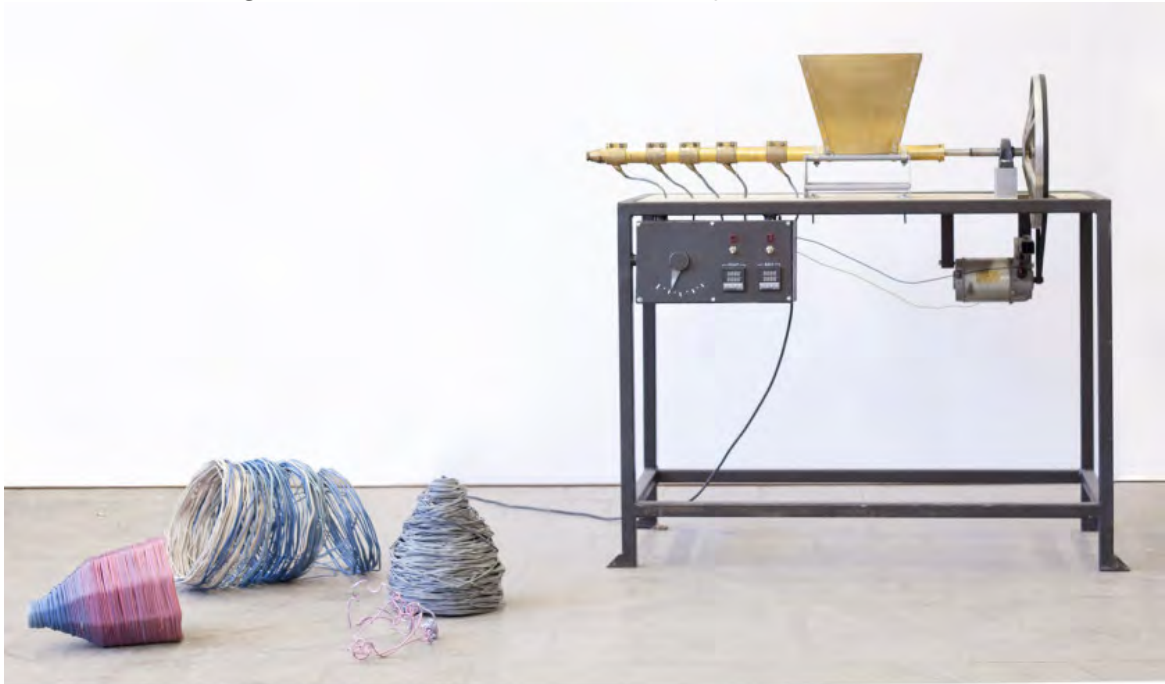
Figura 70 – Extrusora desenvolvida no projeto Precious Plastic
