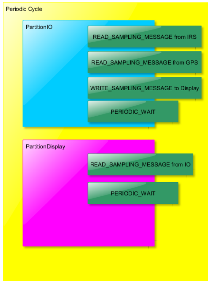
Figura 5.16 – VxWorks 653 Chamadas de Sistema na execução periódica
