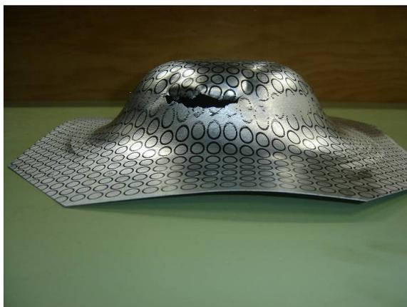
*Figura 46: peça estampada com ângulo de parede de 65°. Grandes deformações causadas pelo acúmulo de tensões residuais e rompimento da chapa causado pela drástica diminuição da espessura da chapa durante o estiramento.*
